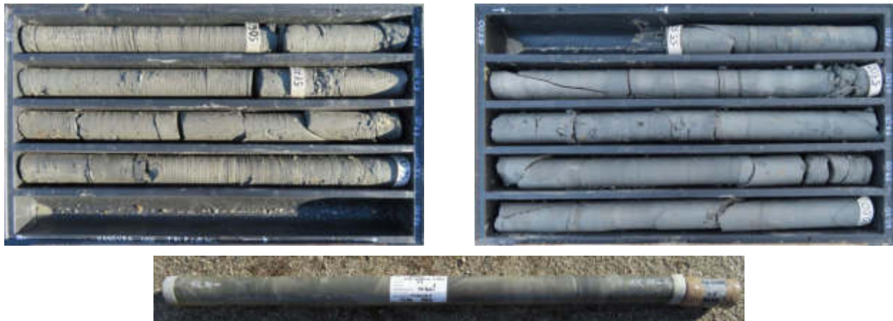
Figura 25. Carote del sondaggio S1, tratto da 55 a 60 m. In basso lo spezzone di carota da 54 a 55,5 m
