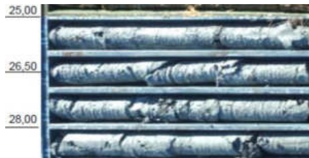
Figura 11. Foto del sondaggio SN2106: livello arenaceo intensamente fratturato a profondità compresa tra 25,0 e 29,0 m s.p.c.
