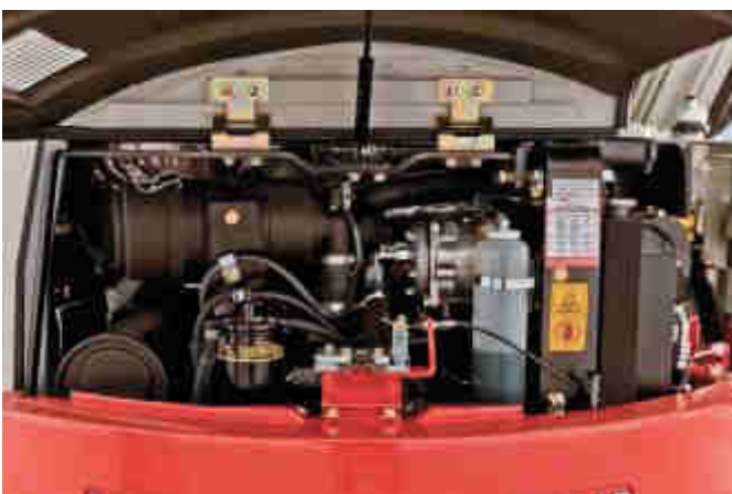
Radiatore side-by-side per olio idraulico e liquido refrigerante motore.
