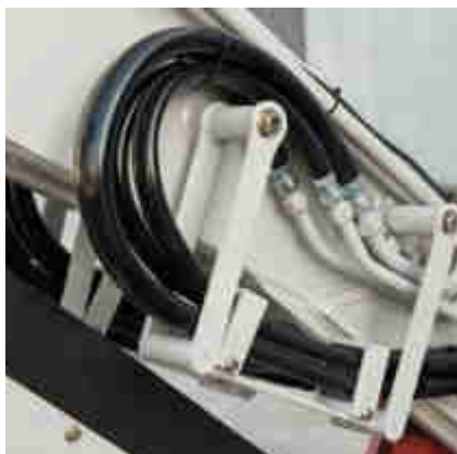
Sistema a culla per accompagnare le tubazioni idrauliche senza stress durante il movimento del braccio.
