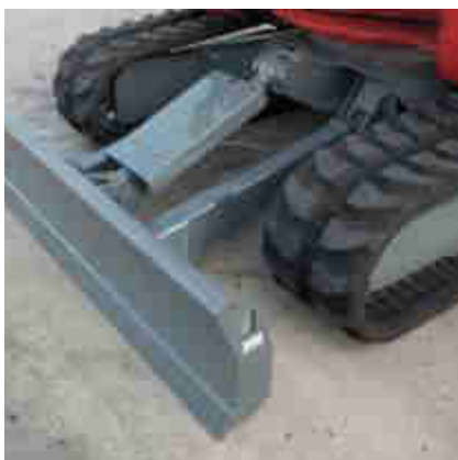
Lama Dozer rinforzata per lavori di reinterro con protezione cilindro.
