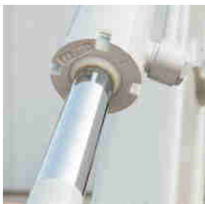
Cilindri idraulici ammortizzati con guarnizioni speciali antipolvere e protezione dello stelo.
