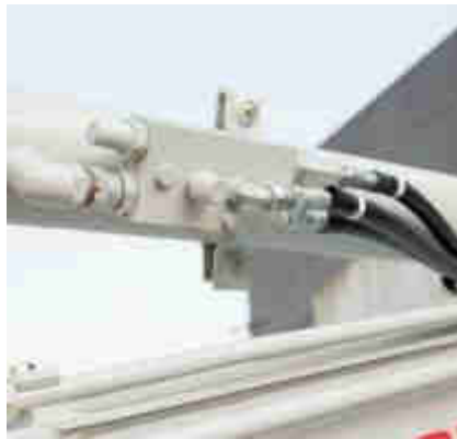
Valvole di sicurezza anticaduta su braccio e avambraccio con allarme di sollevamento, per la movimentazione dei carichi sospesi come da norma con riferimento sul certificato di omologazione della macchina.
