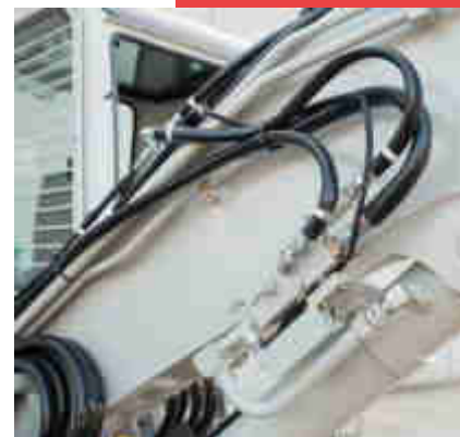
Valvole di sicurezza anticaduta su braccio e avambraccio con allarme di sollevamento, per la movimentazione dei carichi sospesi come da norma con riferimento sul certificato di omologazione della macchina.
