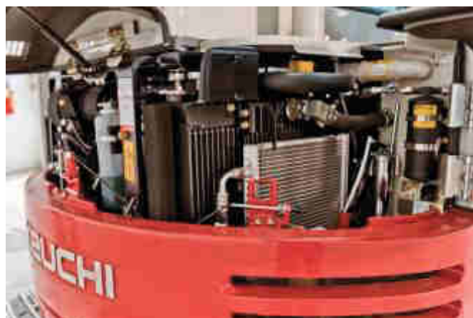
Takeuchi esegue il lavaggio dell'impianto idraulico al termine della linea produttiva e utilizza olio idraulico Long life con sostituzione prevista dopo 4.000 ore .
