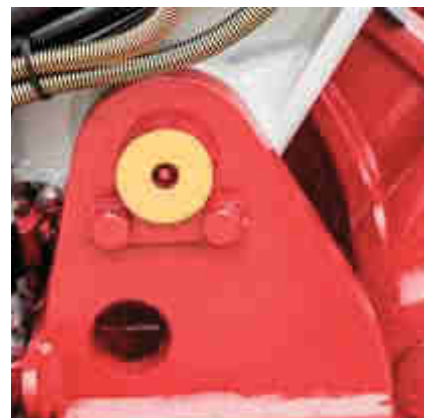
Punti di ingrassaggio ben visibili colorati in giallo.
