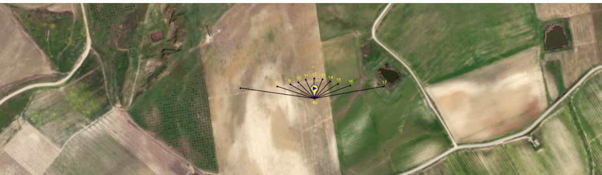
Fig.3.8- Proiezione ombra WTG-01 (21.09 - equinozio d'autunno)
