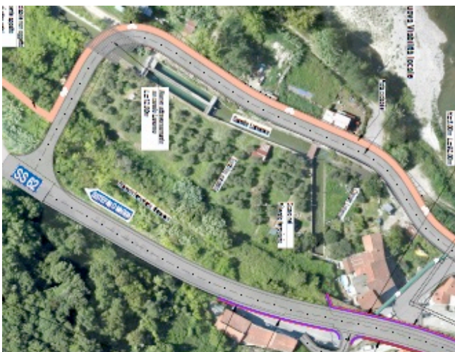
A sinistra la nuova soluzione del PE che non interferisce con l'oliveto, a dx la vecchia soluzione del PFTE che invece interferiva con l'oliveto
