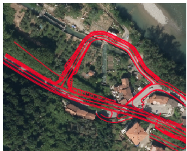
A sinistra la nuova soluzione del PE che non interferisce con l'oliveto, a dx la vecchia soluzione del PFTE che invece interferiva con l'oliveto
