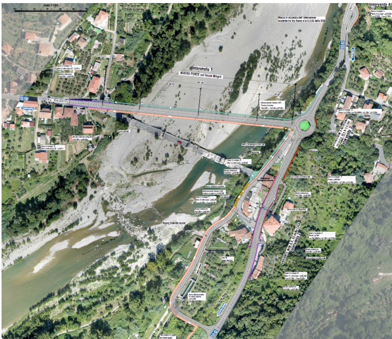
Immagine aerea della zona di intervento con il progetto del nuovo ponte e della riqualificazione della SS 62 "della Cisa"
