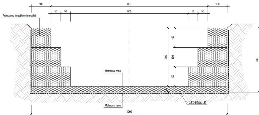
**Figura 4: Sezione tipo inalveazione**
