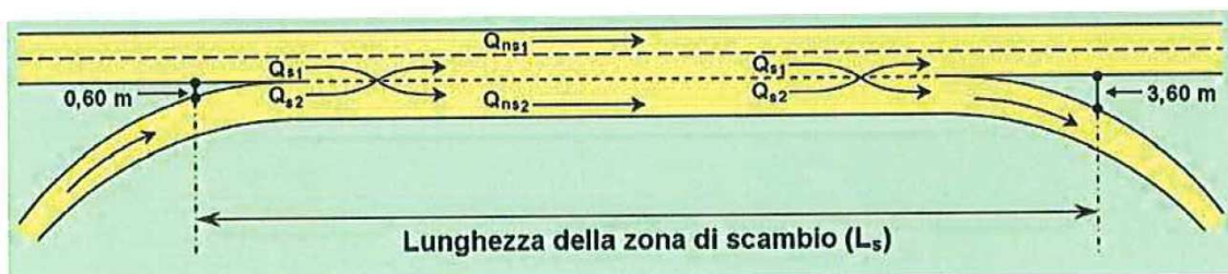
Figura 4: Schema zona di scambio a 3 corsie con indicazione dei flussi veicolari di riferimento
