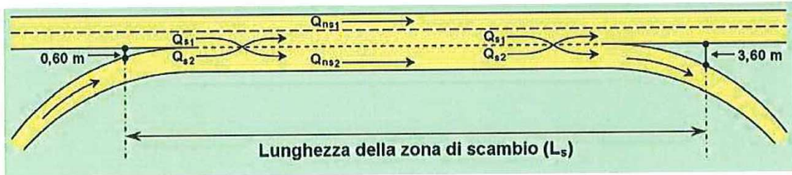
Figura 5: Schema zona di scambio a 3 corsie con indicazione dei flussi veicolari di riferimento
