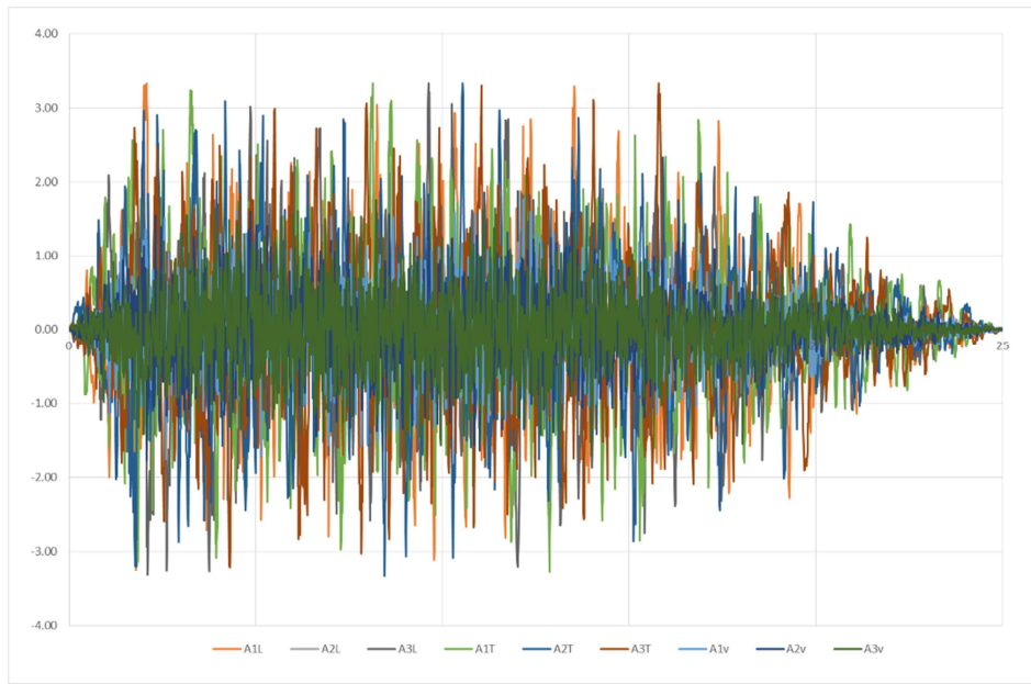
Figura 21 – Accelerogrammi spettrocompatibili (SLC)
