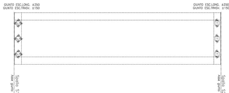
**Figura 34 - Schema appoggi e isolatori**
