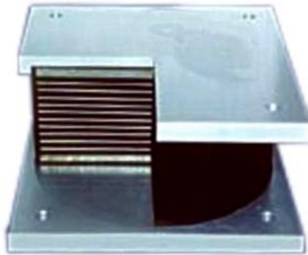
Gli isolatori elastomerici sono dispositivi d'appoggio in elastomero armato, cioè costituiti da strati alterni di acciaio e di elastomero collegati mediante vulcanizzazione.
