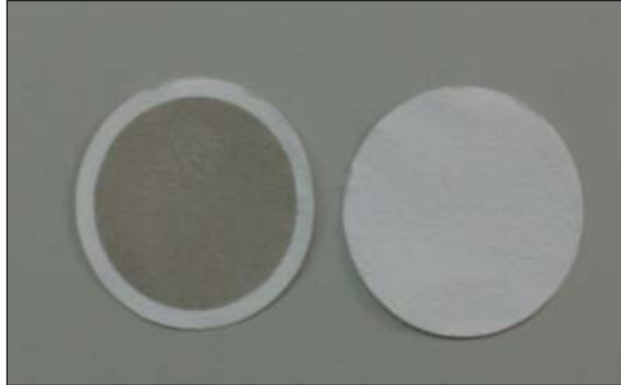
Figura 4.4.1b Esempio di Filtro post e pre campionamento
