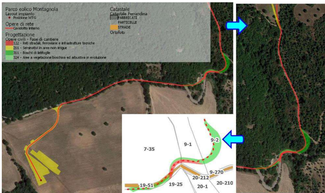
Figura 29: Classificazione d'uso del suolo delle aree utilizzate in fase di cantiere (Zona FER-A6)
