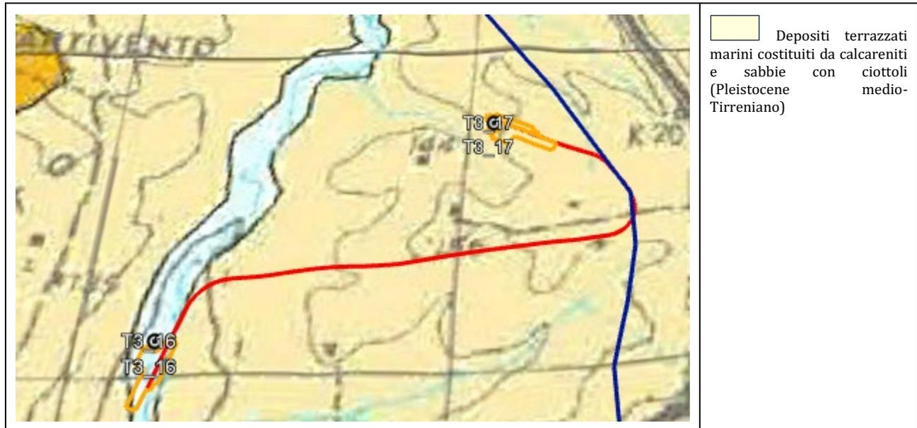
Da un punto di vista litologico gli areogeneratori ubicati in quest'area insistono su di un substrato che è di matrice di tipo arenaceo ricoperto da uno strato eluviale di medio spessore costituito da scaglie e frammenti da angolari a subangolari di dimensioni centimetriche derivanti dal disfacimento del substrato litoide in parte alterate per argillificazione ed ossidazione da "e" a "con" limo sabbioso argilloso da debolmente umido a umido. Lo spessore massimo è di circa di 2-3 m.
