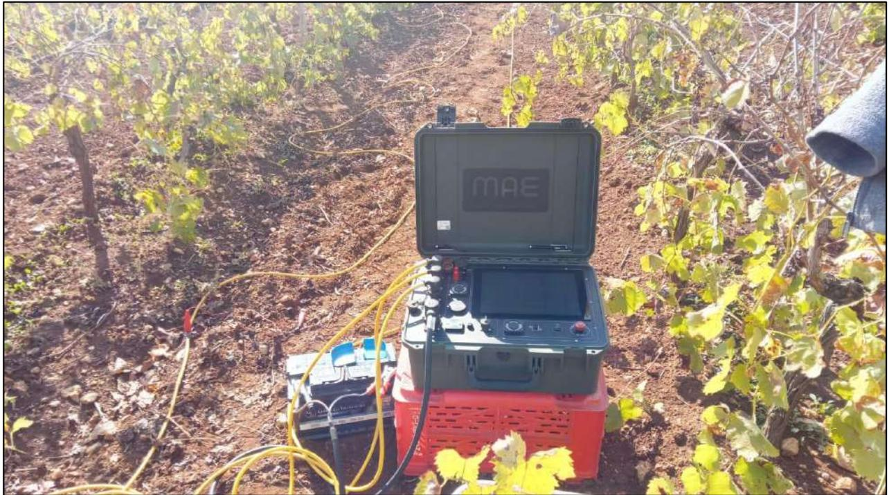
**Figura 23.** Georesistivimetro M.A.E. X612-EM+ (postazione T2 MM3-G14\_ERT1).
