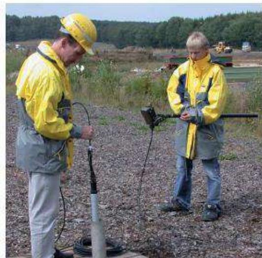
*Sondaggio di fori di trivellazione*
