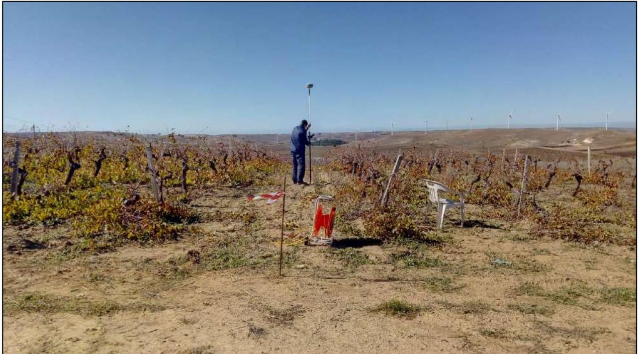
Figura 27. Sistema GPS/GNSS Stonex S8 Plus usato (durante il rilievo degli elettrodi T3 MM2-T3\_12\_ERT3).
