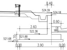
SEZIONE COSTRUTTIVA MURO DI SOTTOSCARPA IN C.A.
