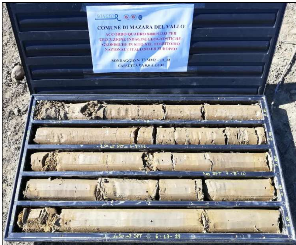
Cassetta Catalogatrice n. 1 Profondità da 00.00 a 5.00 m
