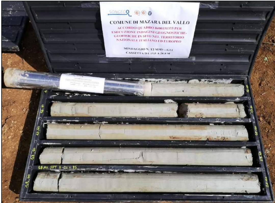
Cassetta Catalogatrice n. 4 Profondità da 15.00 a 20.00 m
