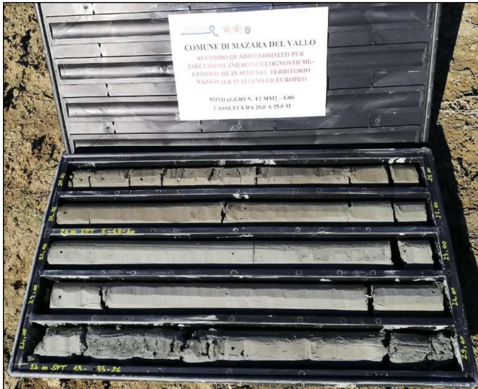
Cassetta Catalogatrice n. 5 Profondità da 20.00 a 25.00 m
