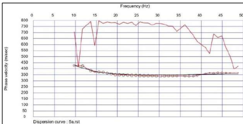
Confronto tra curva di dispersione teorica (curva nera) con la curva sperimentale (curva rossa a pallini)
