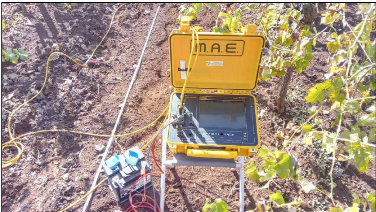
Figura 17. Apparecchiatura modulare per sismica a rifrazione e riflessione M.A.E. A6000S.
