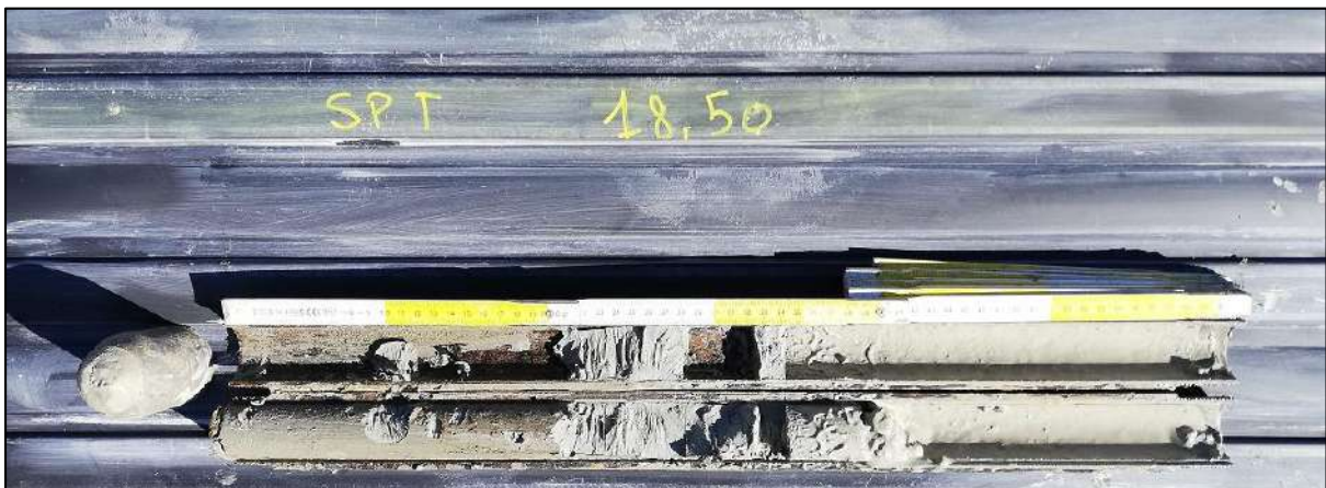
Figura 16. Esecuzione prova SPT10, con punta aperta, durante il sondaggio T2 MM2-G06_S2.
