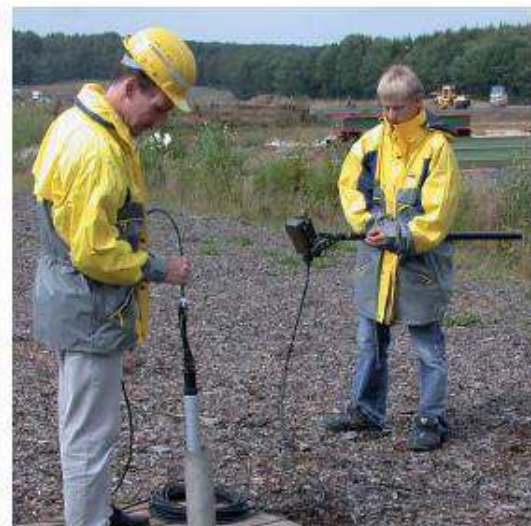
Sondaggio di fori di trivellazione
