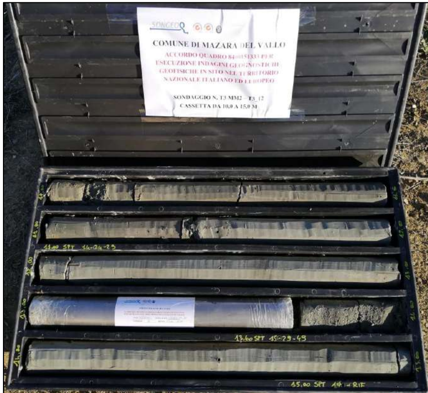
Cassetta Catalogatrice n. 3 Profondità da 10.00 a 15.00 m
