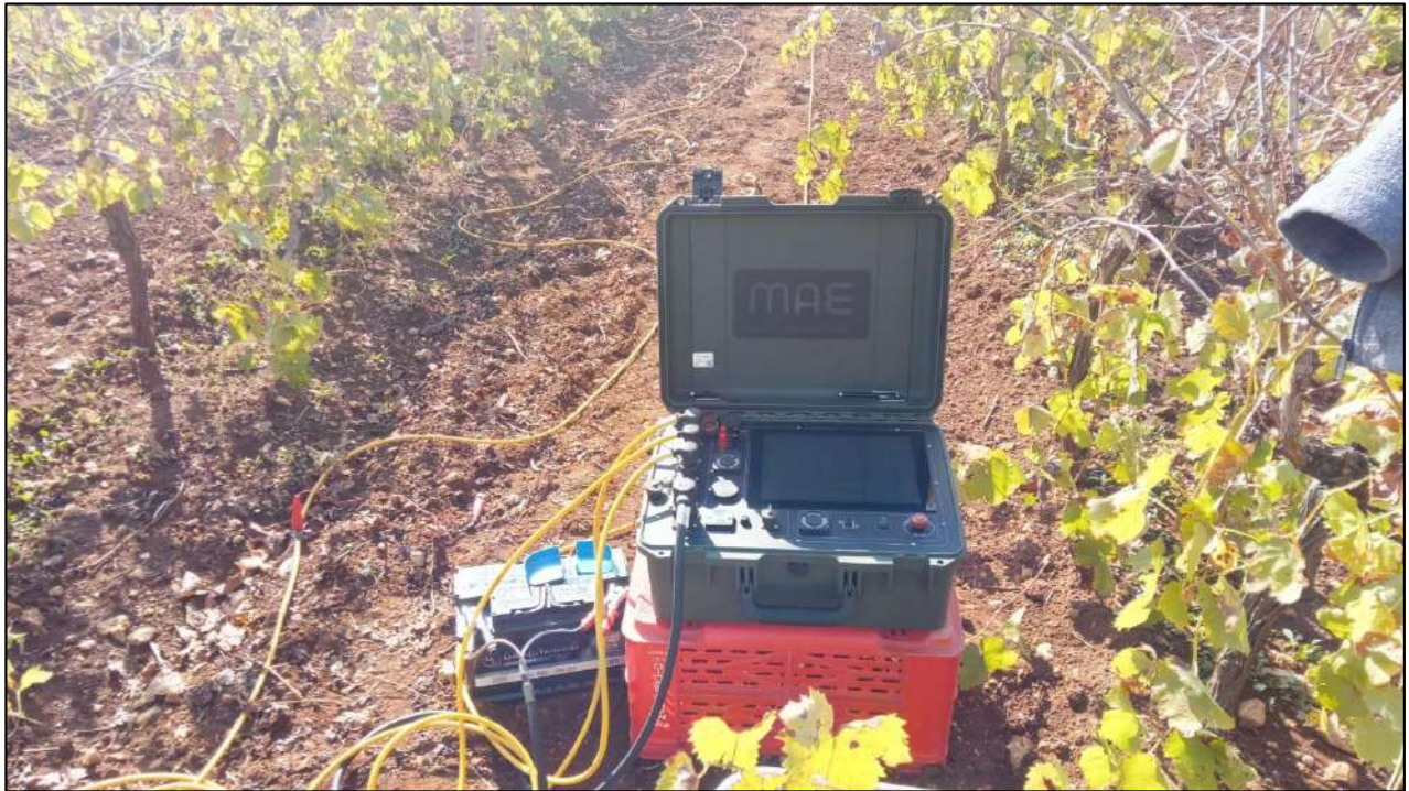
Figura 23. Georesistivimetro M.A.E. X612-EM+ (postazione T2 MM3-G14_ERT1).
