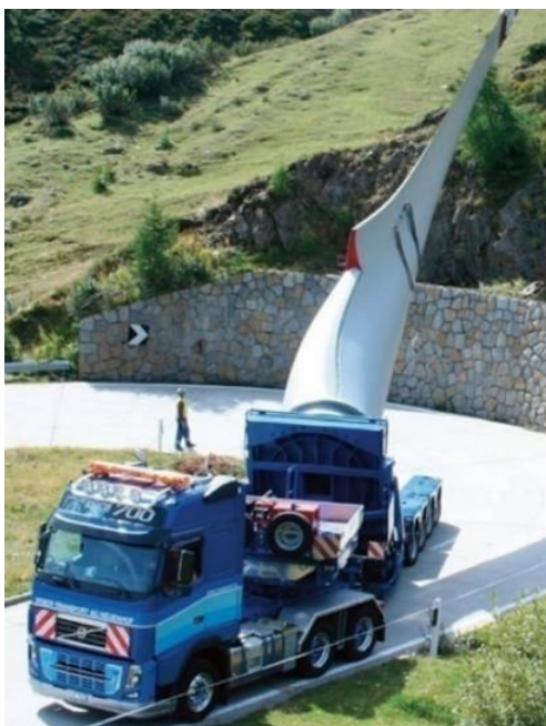
Figura 3-2: Esempio di blade lifter
