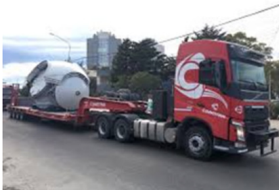
Figura 3-5: Esempio di trasporto del mozzo
