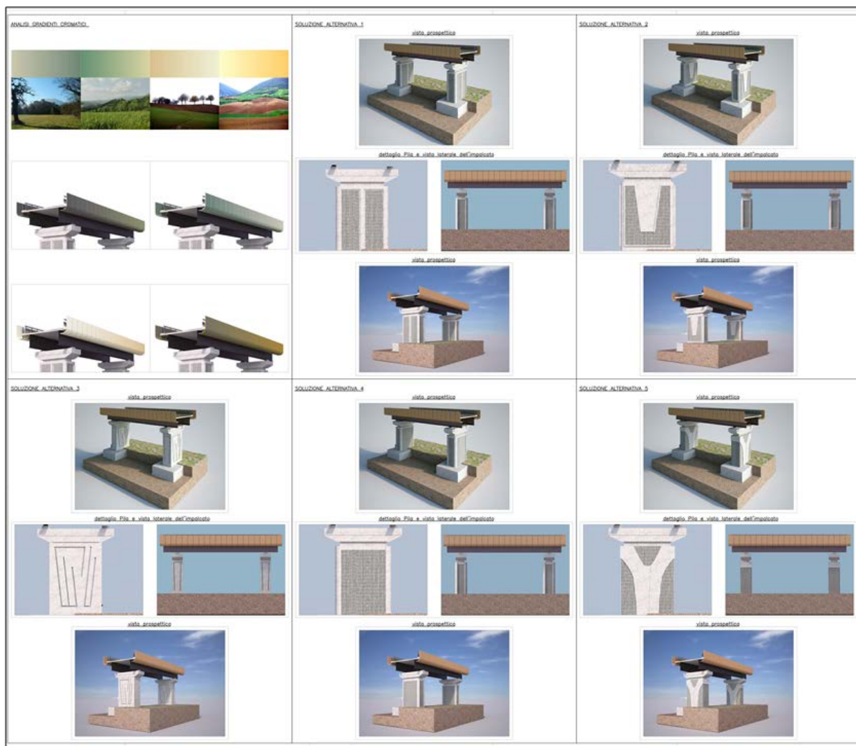
Viadotto Potenza: Studio delle pile e dell'impalcato
