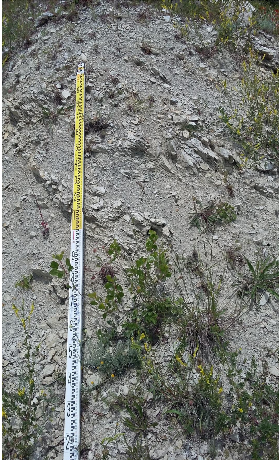
Figura 4.1 Particolare dello Schlier in affioramento nella stazione 1, in prossimità dell'Ospedale di Camerino in cui sono stati eseguiti i rilievi geostrutturali (azimut linea di scansione: N120°E).
