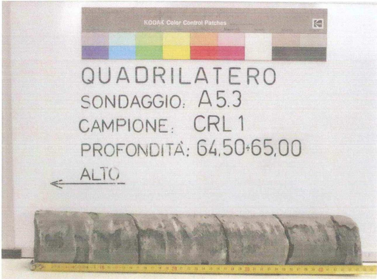
DESCRIZIONE MACROSCOPICA: Roccia di origine sedimentaria a grana fine (siltite) di colore grigio scuro (5Y 4/1) con moderata reazione all'HCl. Debole stratificazione piano parallela inclinata di circa 45°.
