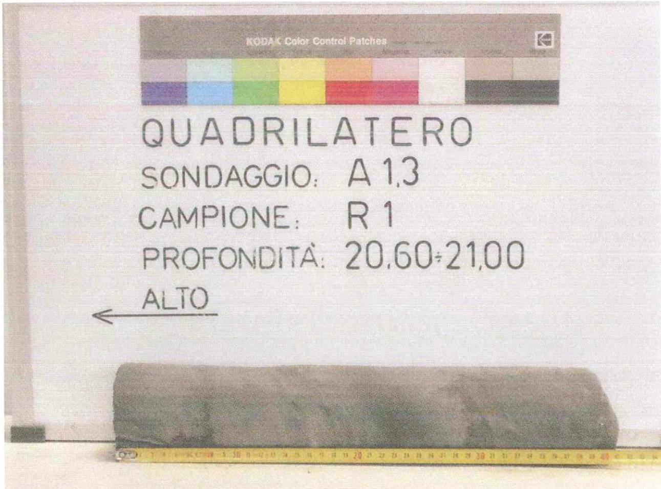
DESCRIZIONE MACROSCOPICA: Roccia sedimentaria a grana fine di colore grigio (5Y 5/1) (arenaria fine), passante ad arenaria alternata a livelli di siltite grigio chiaro inclinati di circa 30°. Il grado di cementazione del campione varia da debole a discreto.
