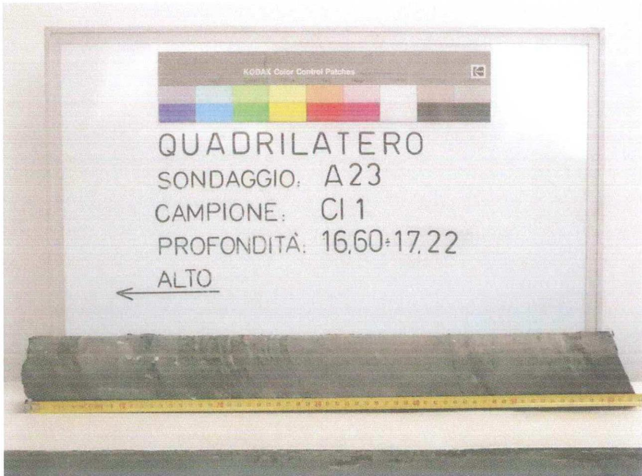
DESCRIZIONE MACROSCOPICA: Alternanza di strati piano paralleli inclinati di circa 30°, da centimetrici a decimetrici, di arenaria da debolmente cementata a cementata di colore grigio e siltite di colore grigio scuro. Buona reazione all'HCl.
