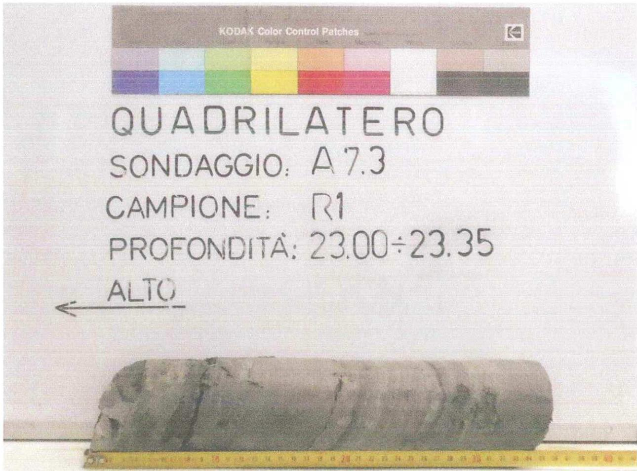
DESCRIZIONE MACROSCOPICA: Roccia sedimentaria a grana fine costituita dall'alternanza di livelli millimetrici di siltite ed argillite inclinati di circa 30° e paralleli, con colore grigio e grigio chiaro. Presenza di rari livelli arenacei fratturati e di uno strato di frizione spesso circa 2 mm costituito da materiale vetroso nerastro lucido parallelo alla stratificazione. Buona reazione all'HCl.
