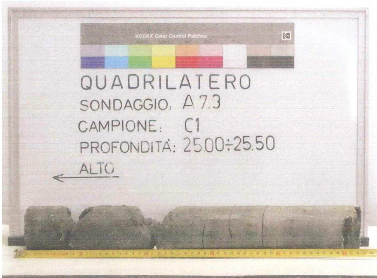
DESCRIZIONE MACROSCOPICA: Roccia sedimentaria a grana fine (siltite argillosa) di colore grigio oliva (5Y 4/2). Presenza di fratture concoidi parallele tra loro, apparentemente inclinate di 30° - 45° e di discontinuità con riempimenti argillosi.
