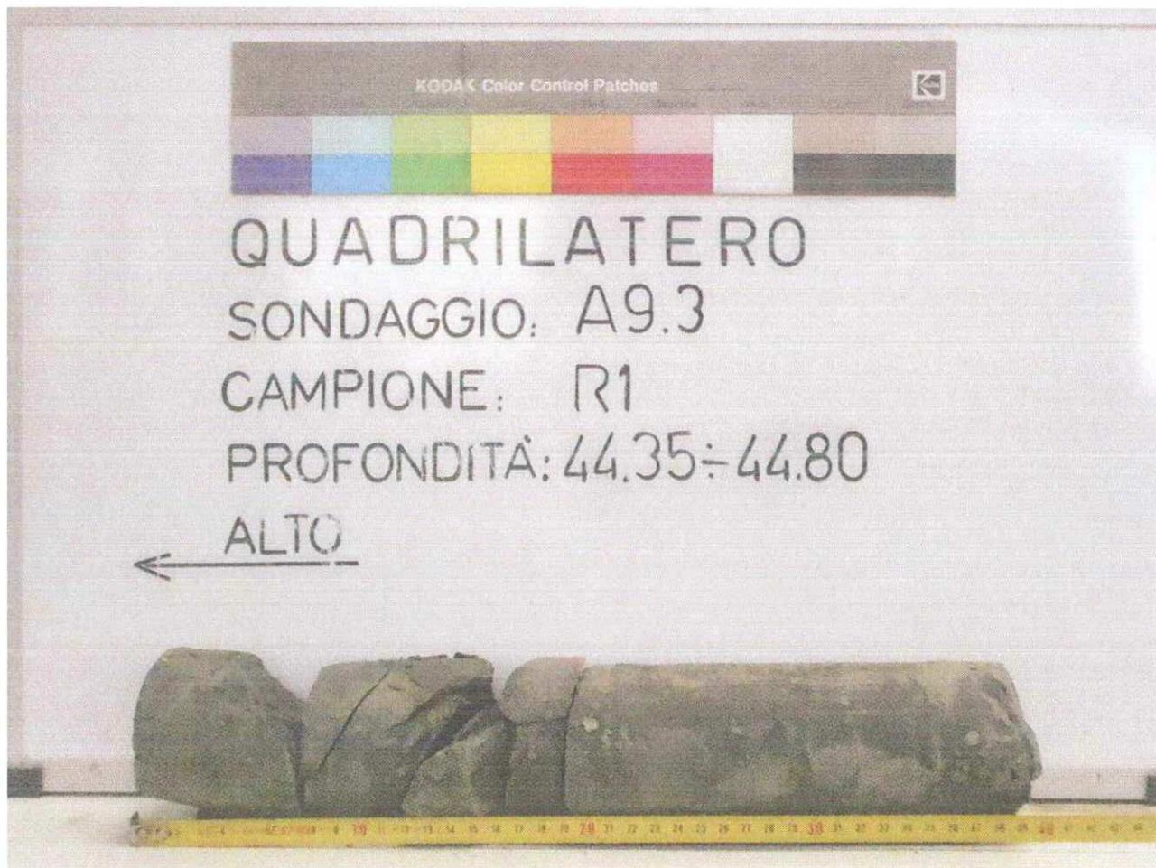
DESCRIZIONE MACROSCOPICA: Roccia sedimentaria a grana medio fine (siltite arenacea) di colore oliva (5Y 5/3) con buona reazione all'HCl. Presenza di discontinuità variamente orientate con locali superfici lucide lisce o striate.
