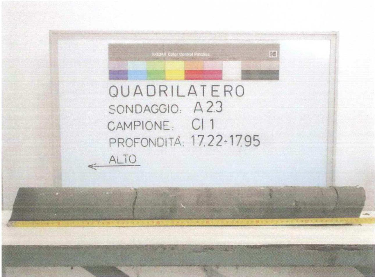
DESCRIZIONE MACROSCOPICA: Debole alternanza di strati piano paralleli inclinati di circa 30°, da centimetrici a decimetrici, di arenaria da debolmente cementata a cementata di colore grigio e siltite di colore grigio scuro. Buona reazione all'HCl.
