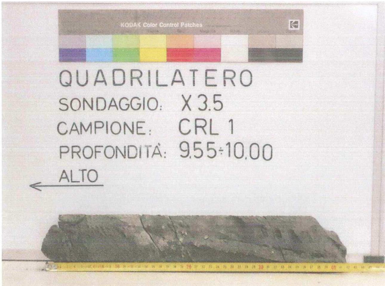
DESCRIZIONE MACROSCOPICA: Roccia sedimentaria a grana fine di colore grigio scuro (siltite semilitoide). Presenta debole stratificazione inclinata di circa 30° da planare a debolmente ondulata. Presenza di locali fratture concoidi e segni evidenti del carotiere. Buona reazione all'HCl.
