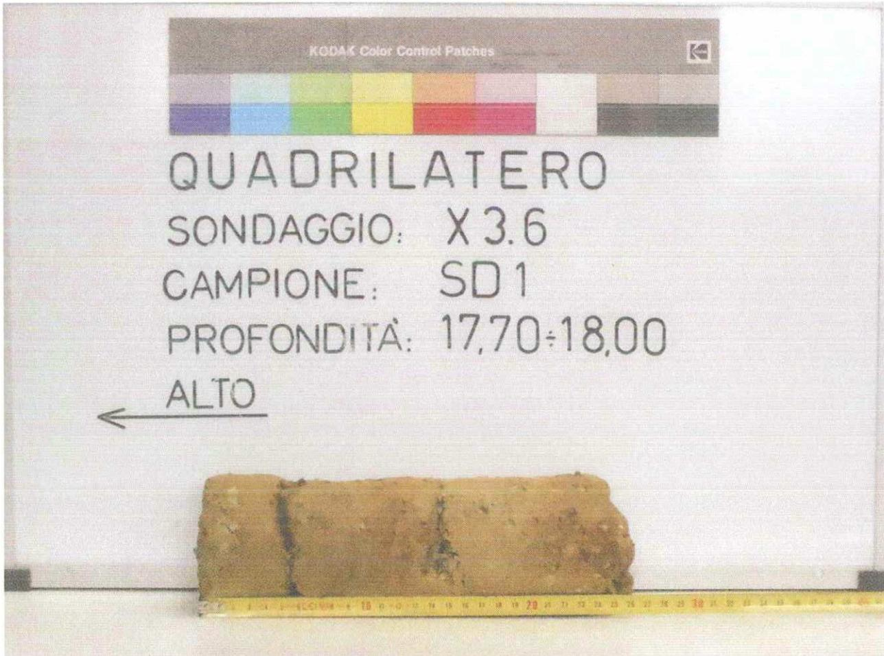
DESCRIZIONE MACROSCOPICA: Limo con sabbia, localmente sabbia limosa, di colore oliva giallastro (2.5Y 6/8). Presenza di elementi lapidei con Lmax = 30 mm sparsi o concentrati in livelli. Buona reazione all'HCl.
