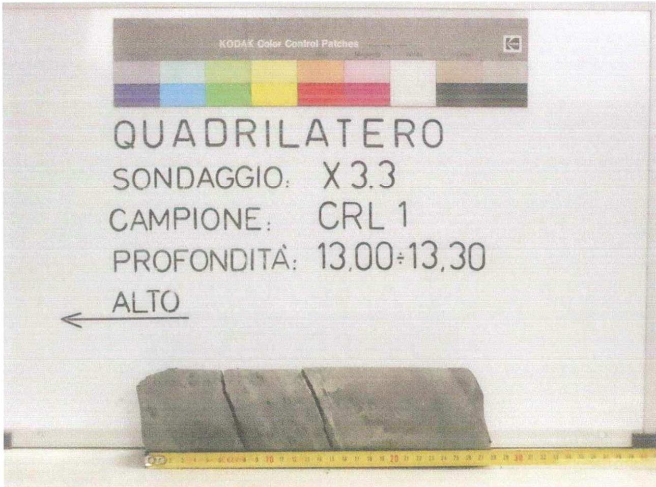
DESCRIZIONE MACROSCOPICA: Argillite caratterizzata da lineazioni da subplanari ad inclinate di circa 30° da 13.03 m a 13.17 m e da 13.29 m a 13.30 m, di colore grigio scuro (5Y 4/1). Da 13.17 m a 13.29 m arenaria ben cementata di colore grigio (5Y 5/1). Il campione presenta buona reazione all'HCl e due superfici di rottura.
