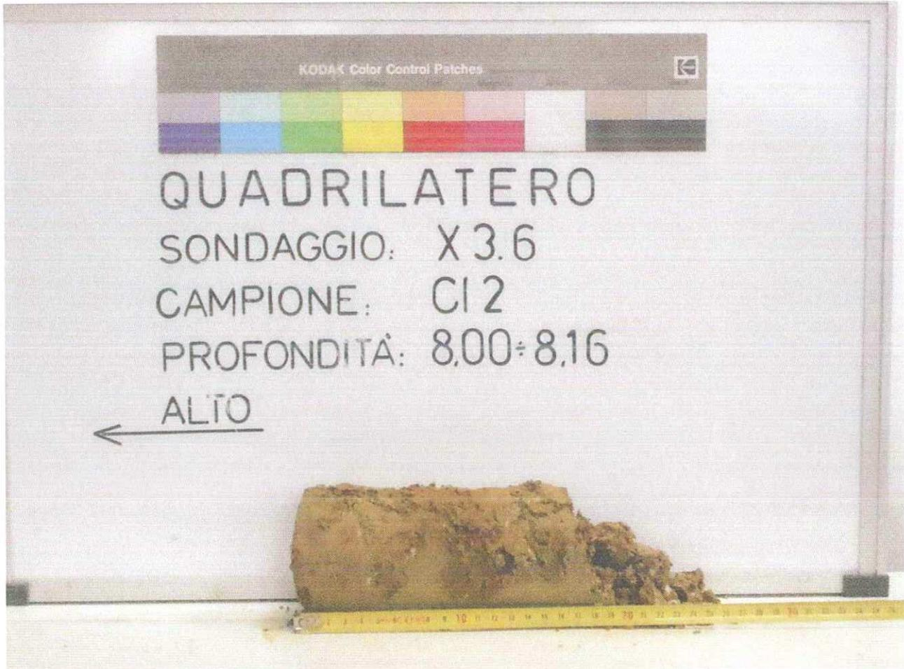
DESCRIZIONE MACROSCOPICA: Sabbia da debolmente limosa a limosa di colore oliva giallastro (2.5Y 6/8). Presenza di elementi lapidei sparsi con  $L_{max} = 35$  mm. Buona reazione all'HCl. Il campione risulta disgregato.
