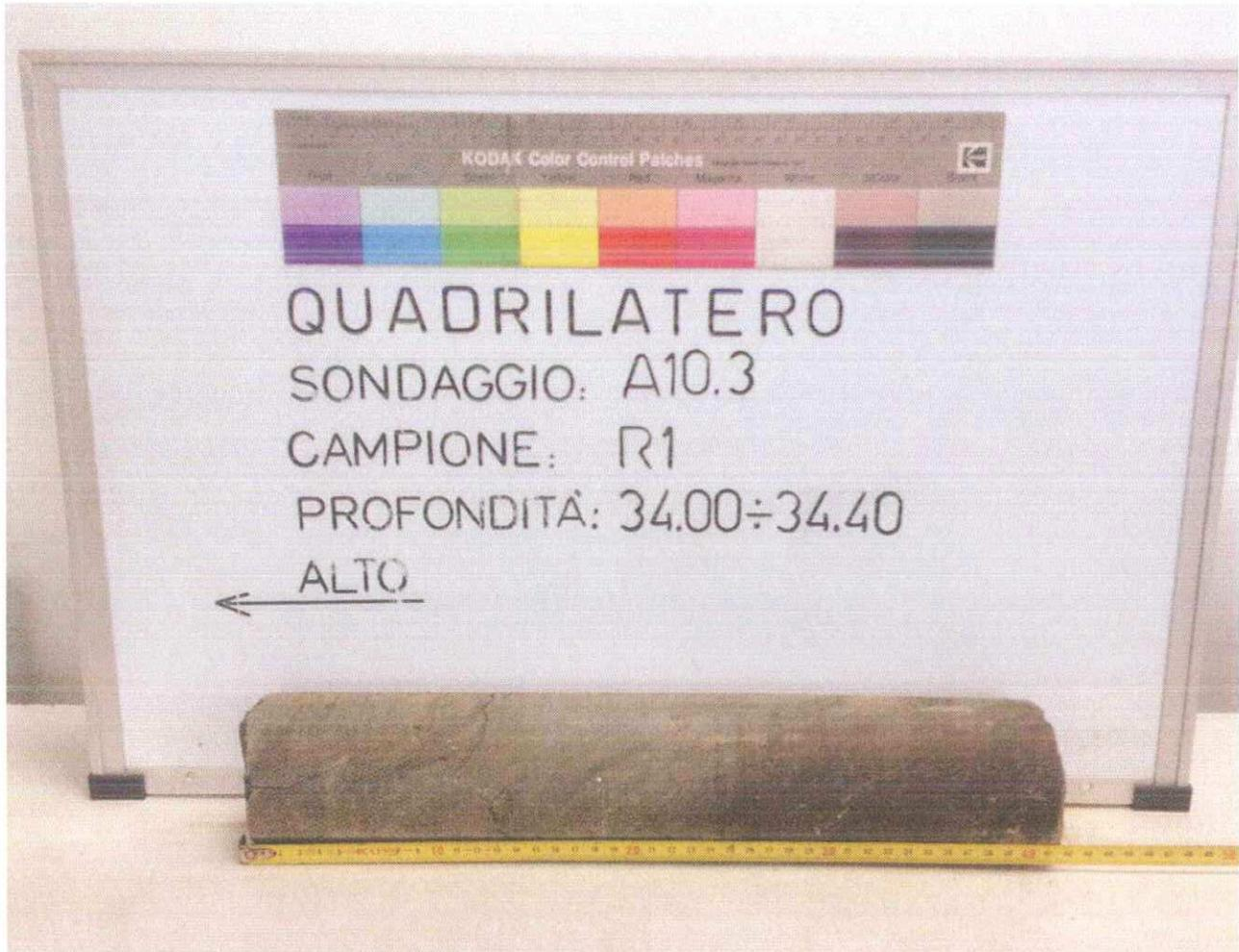
DESCRIZIONE MACROSCOPICA: Roccia sedimentaria a grana medio fine (arenaria siltosa) di colore grigio scuro (5Y 4/1) con buona reazione all'HCl. Presenza di discontinuità chiuse variamente orientate e concentrate prevalentemente nella parte alta del campione.
