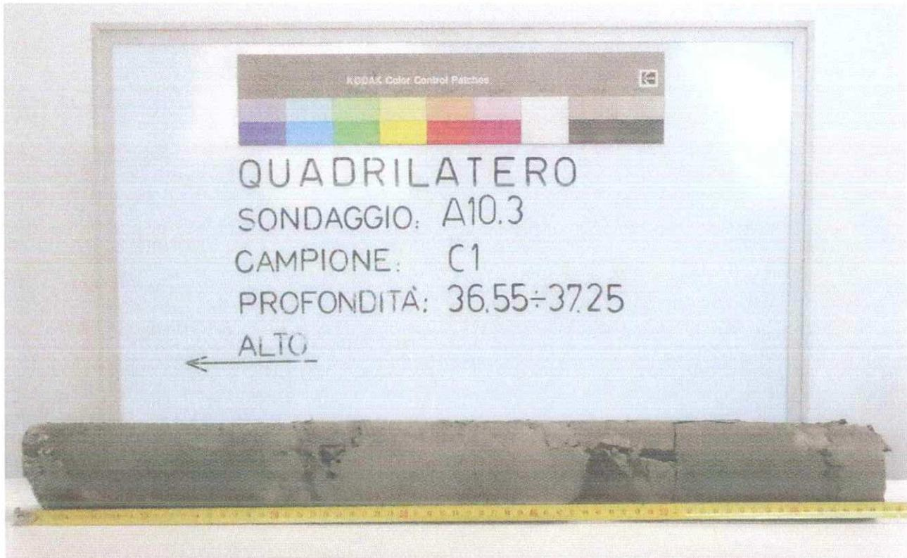
DESCRIZIONE MACROSCOPICA: Roccia sedimentaria a grana fine data dall'alternanza di siltite debolmente arenacea e argillite di colore oliva (5Y 4/4) con discreta reazione all'HCl. Presenza di fratture subverticali planari con superficie lucida e striate inclinate di circa 45°.
