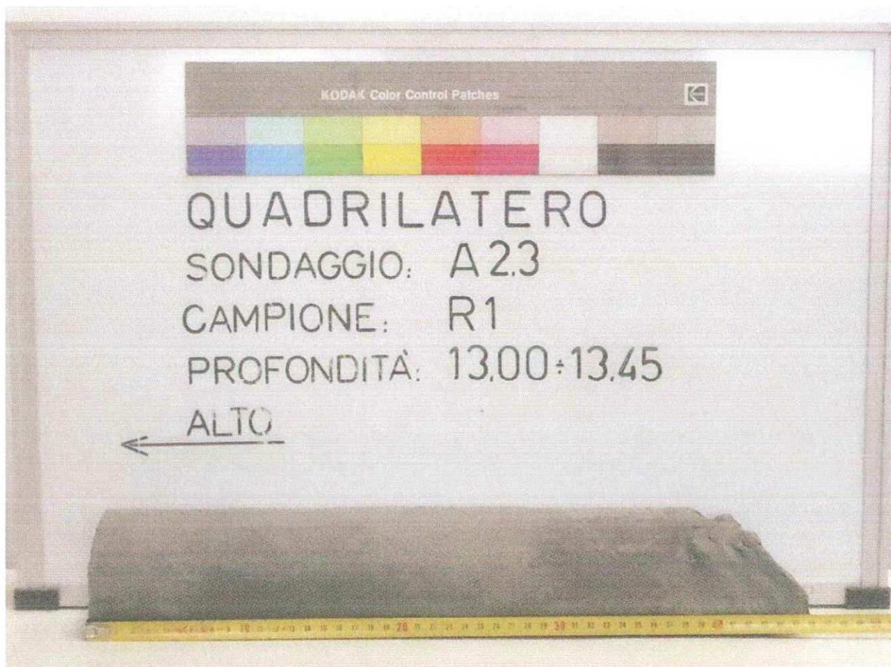
DESCRIZIONE MACROSCOPICA: Arenaria massiva di colore grigio passante ad arenaria con livelli siltitici ondulati ed inclinati di circa 45° di colore grigio scuro nella parte terminale del campione. Buona reazione all'HCl.
