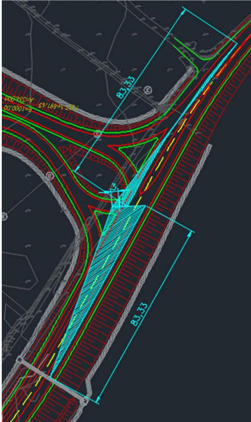
Figura 26: Svincolo di Castelraimondo Sud / Pioraco: Intersezione a T Rampa A Immissione Nord - Triangoli di visibilità
