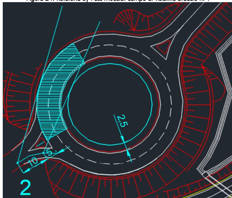
Figura 25: Rotatoria By-Pass Muccia: campo di visibilità braccio n. 2
