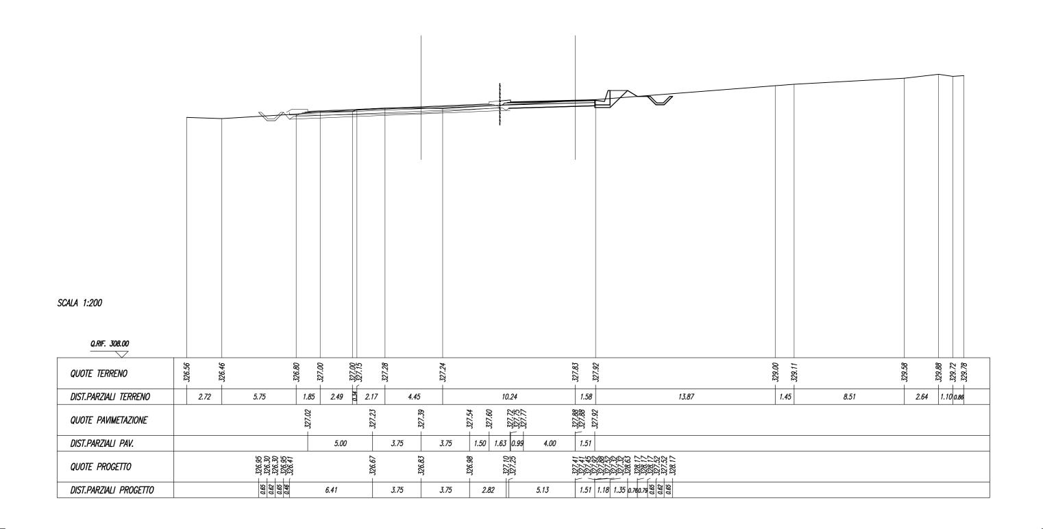
SCAVI E BONIFICHE STERRO SCOTICO BONIFICA – TRATTAMENTO IN SITU COMPATTAZIONE FONDO SCAVO 6.77 sqm 4.18 m 4.27 m 4.84 m RILEVATI RILEVATO TERRENO VEGETALE SOVRASTRUTTURA STRATO DI USURA STRATO DI BINDER STRATO DI BASE STRATO DI FONDAZIONE 6.50 m 6.73 m 6.97 m 1.92 sqm
