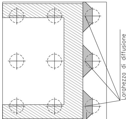
Figura 33 – Diffusione delle azioni dal palo al muro frontale
