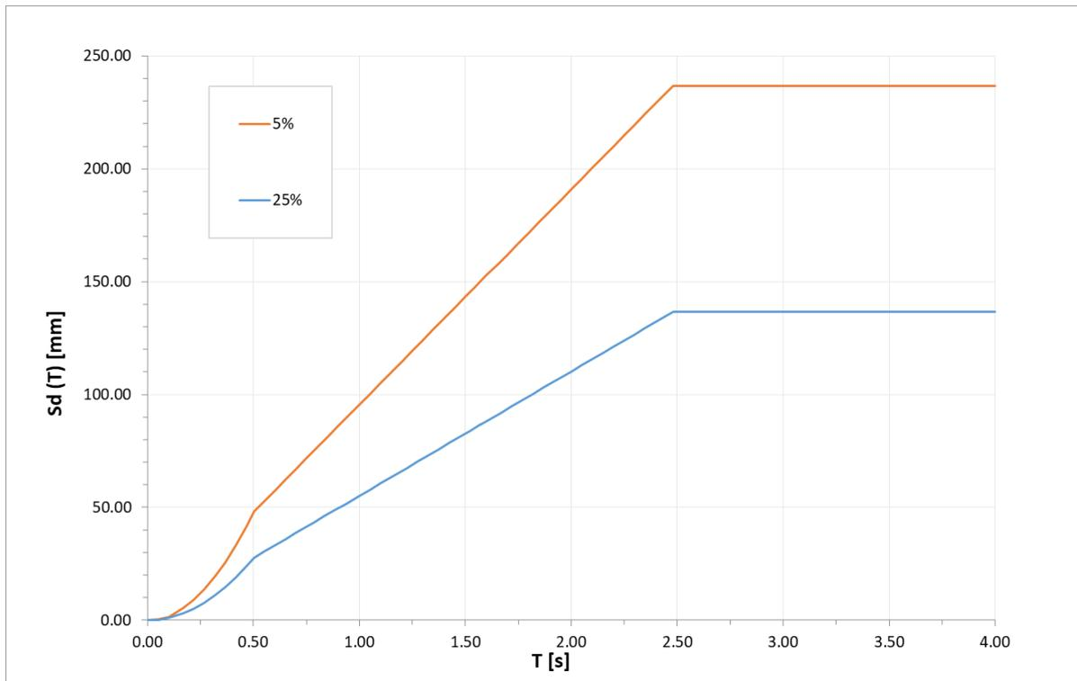
Figura 18 – Spettri in spostamento allo SLV
