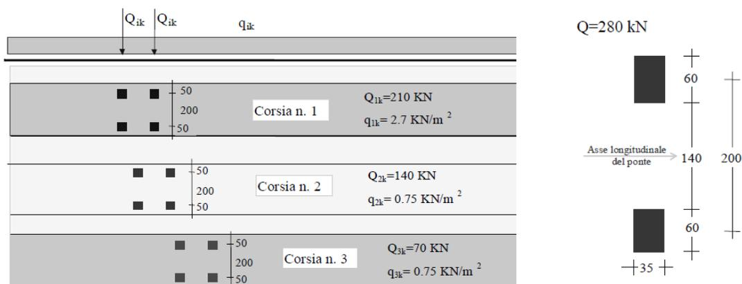
Figura 13 – Modello di carico a fatica: schemi di carico 1 e 2
