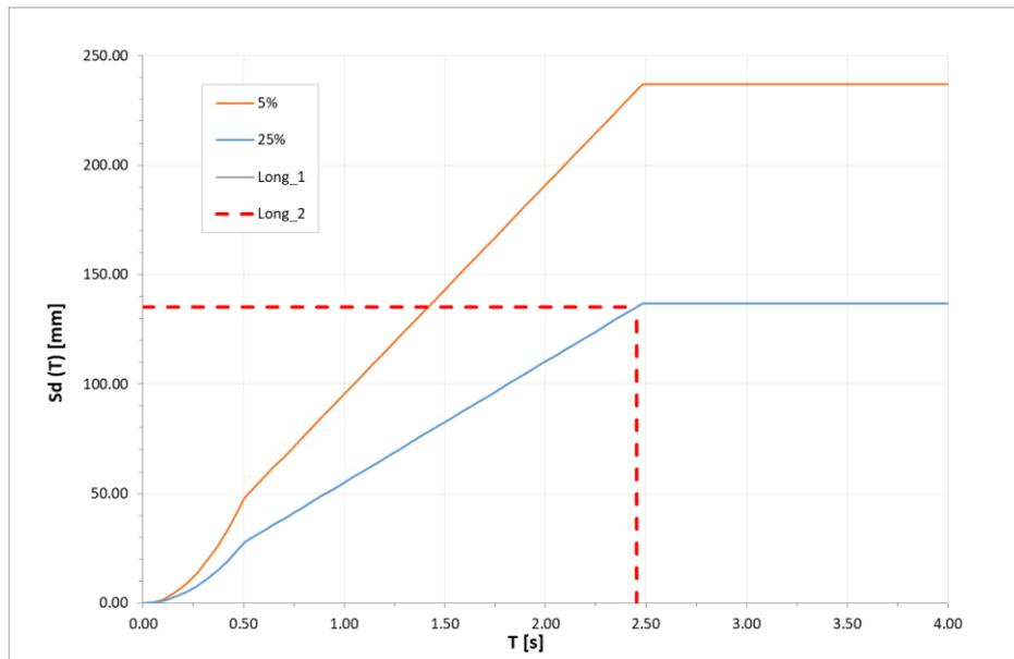
Figura 23 - Relazione fra spostamento di soglia e periodo di progetto (direzione longitudinale)
