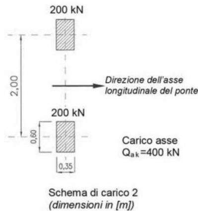
Figura 12 – Schema di carico 2
