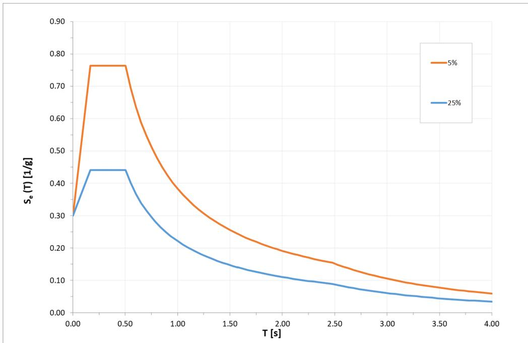
Figura 16 – Spettri elastici in accelerazione allo SLV
