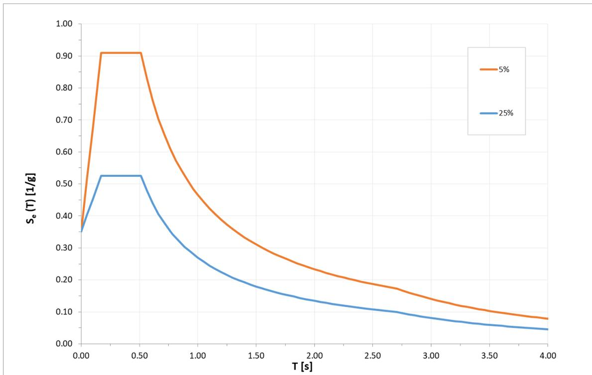
Figura 17 – Spettri elastici in accelerazione allo SLC
