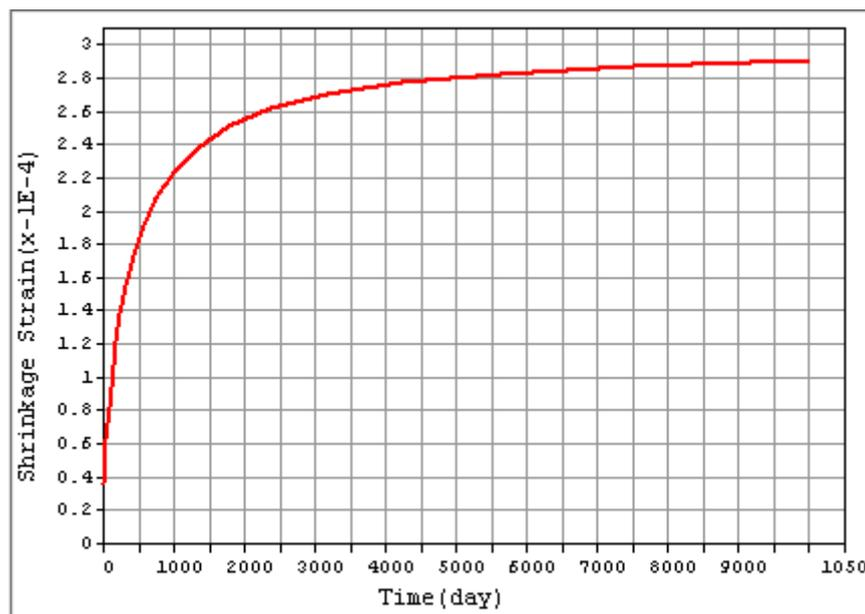
Figura 6 - Andamento della deformazione da ritiro nel tempo
