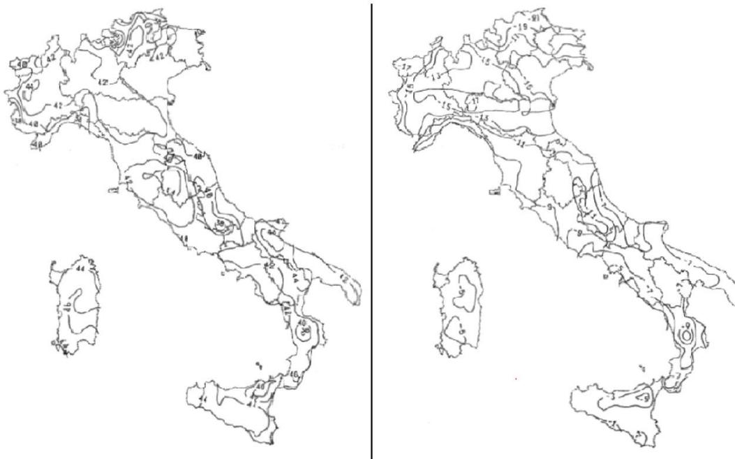
Figura 8: Mappe nazionali delle linee isoterme;  $T_{max}$  a sinistra e  $T_{min}$  a destra (Appendici nazionali, 2007)
