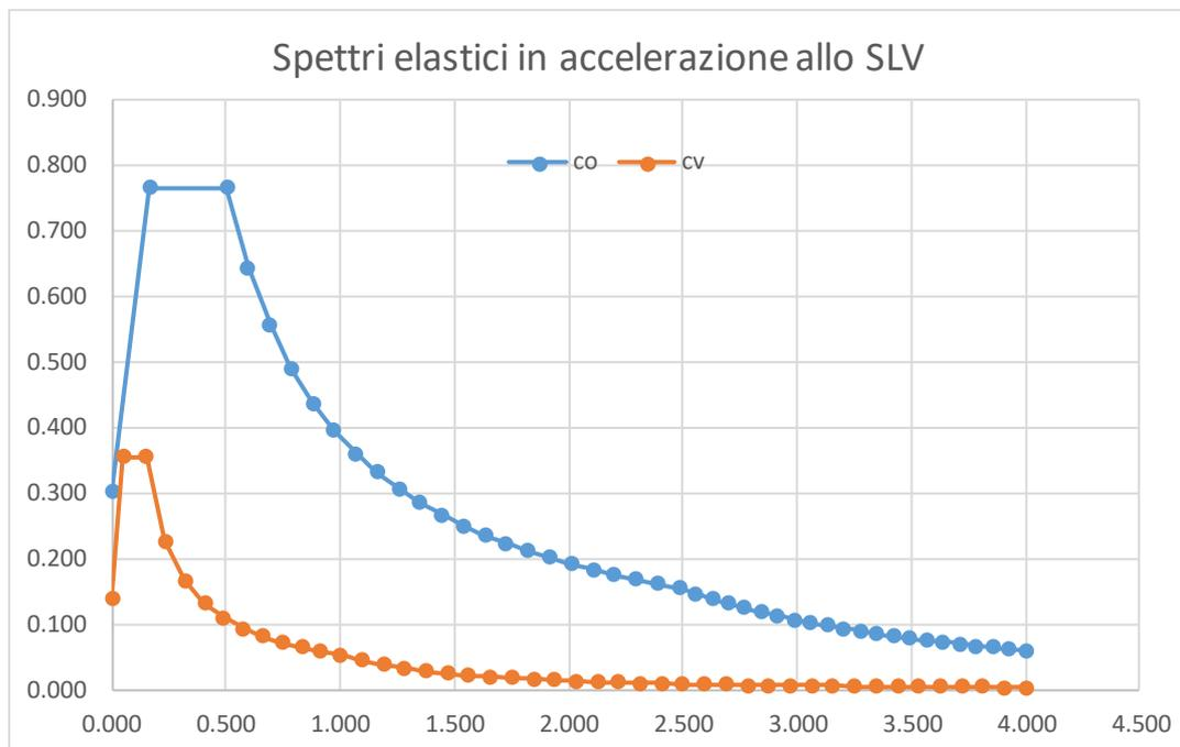
Figura 15 – SLV: Spettri elastici in accelerazione ( $q = 1$ )
