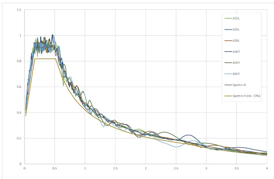
**Figura 29 – Accelerogrammi spettrocompatibili**
