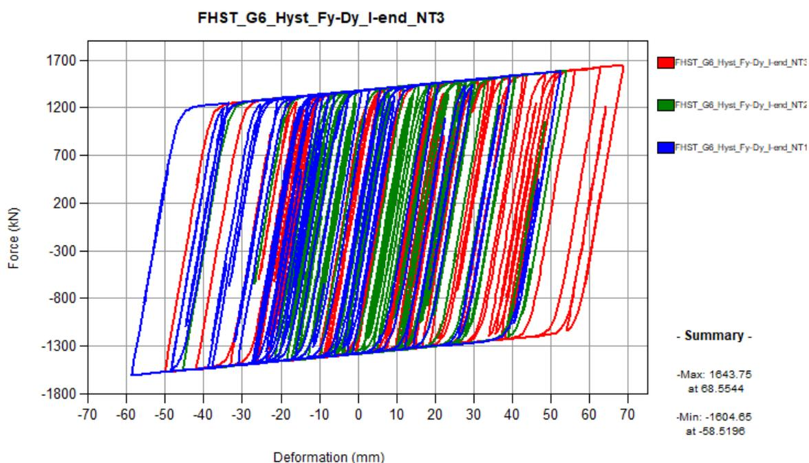
**Figura 32 – Legame forza-spostamento nei dispositivi di isolamento trasversale durante gli eventi sismici 1, 2 e 3**
