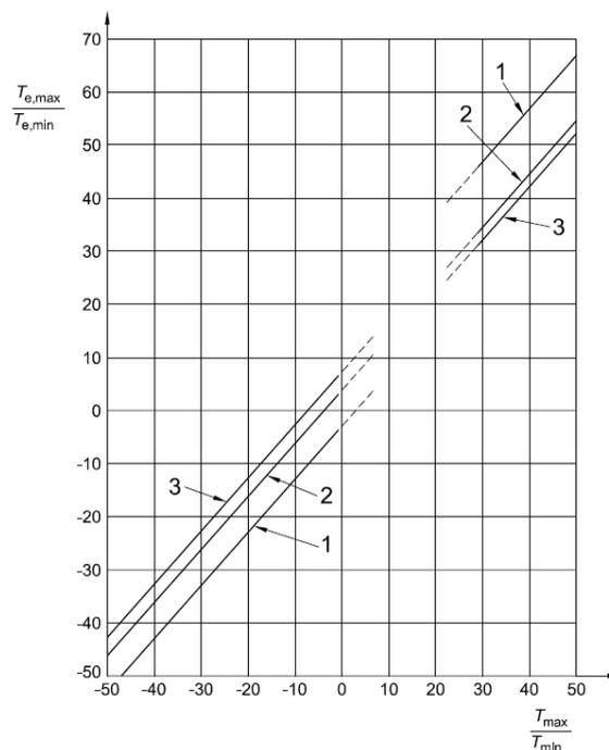
Figura 10: Correlazione tra temperatura dell'aria all'ombra minima/massima ( $T_{min}/T_{max}$ ) e componente di temperatura uniforme del ponte minima/massima ( $T_{e,min}/T_{e,max}$ )
