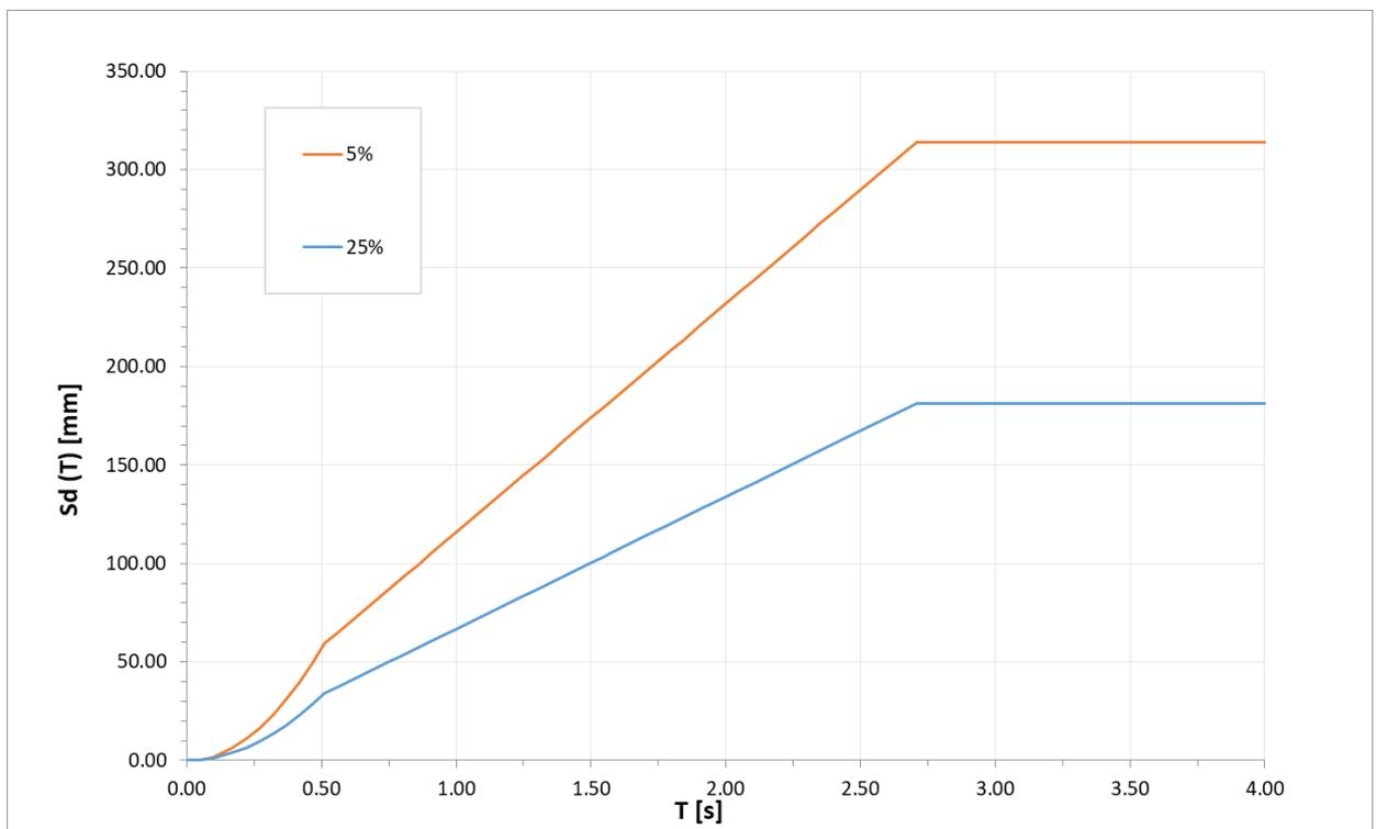
Figura 19 – Spettri in spostamento allo SLC
