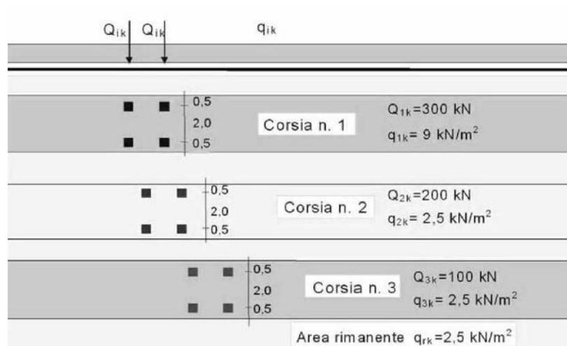
**Figura 11 – Schema di carico 1**
