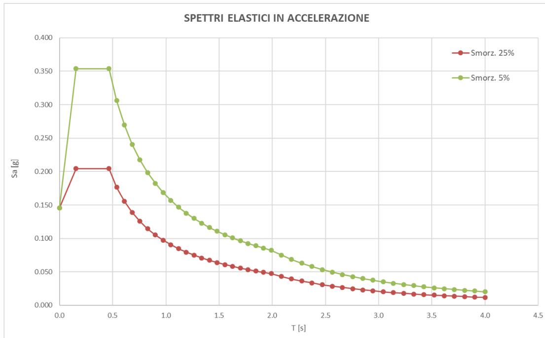
Figura 14 – Spettri elastici in accelerazione allo SLD
