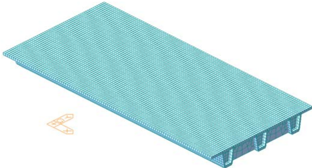
Figura 16: Modello FEM– Vista 3D
