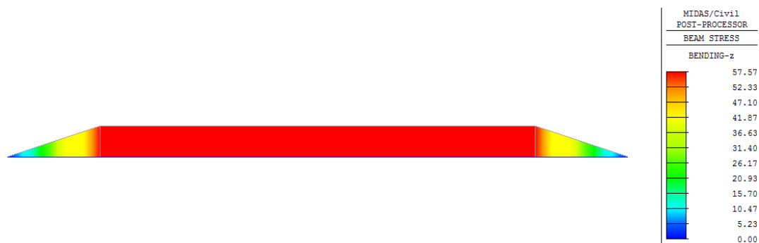
Figura 60 – Sollecitazioni allo SLU agenti nei traverzi di testata in fase di sollevamento
