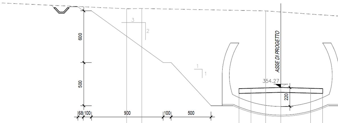
Modello Geometrico Sezione di Scavo Analizzato
