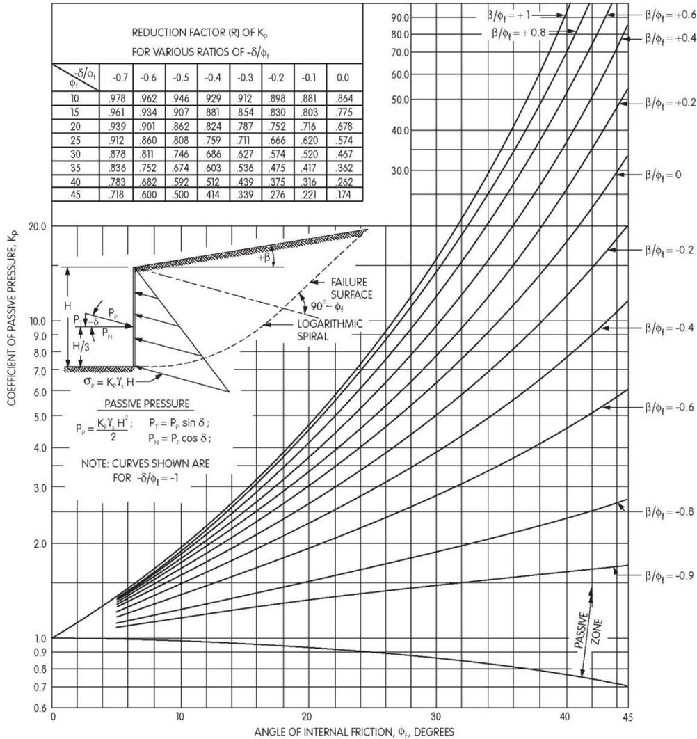
Figura 11– modello a spirale logaritmica per il calcolo dei coefficienti di spinta
