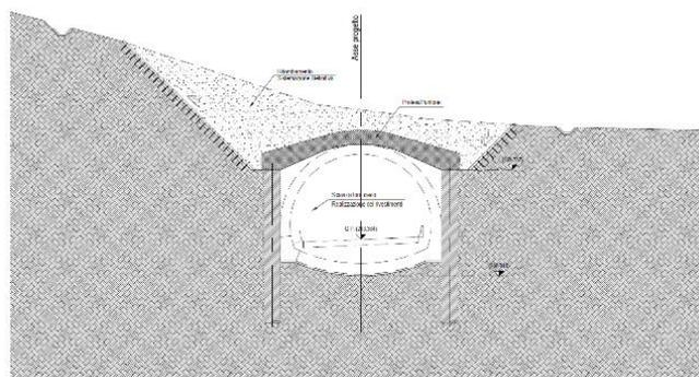
Figura 9: Fase di Scavo a foro cieco
