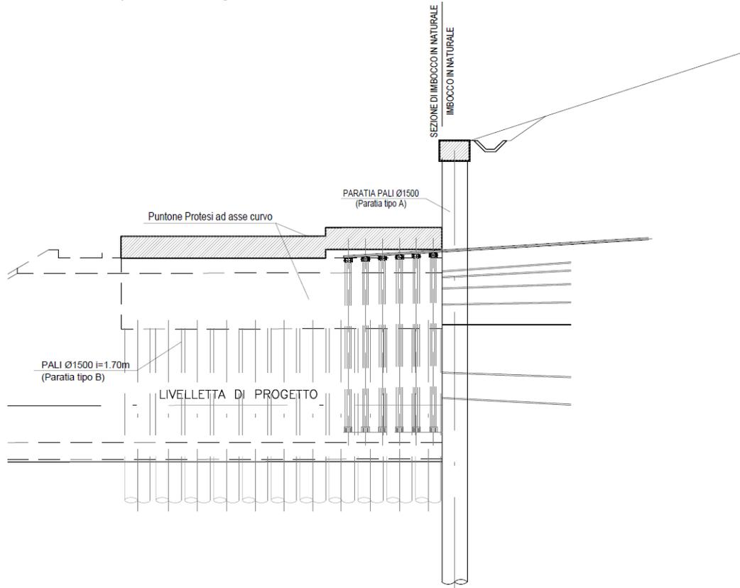
Figura 10: Sezione Longitudinale tipo in corrispondenza Imbocco in Naturale
