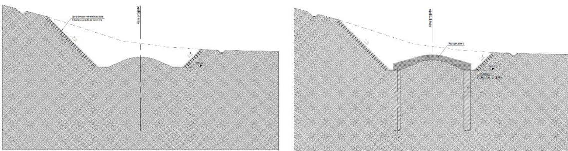
Figura 8: Fasi di scavo per la realizzazione della protesi in c.a.
