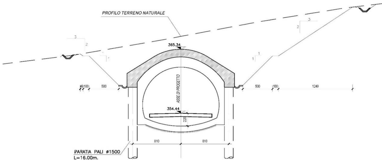
**Figura 6: Sezione "Artificiale con protesi e pali" – Imbocco B (lato Sud)**
