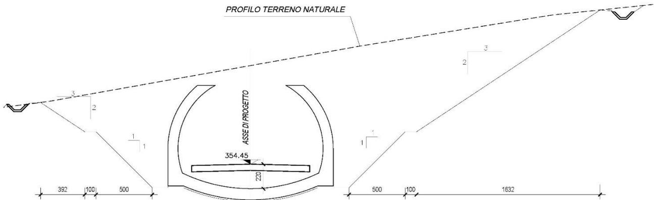
**Figura 4: Sezione "Artificiale in scavo" – Imbocco B (lato Sud)**
