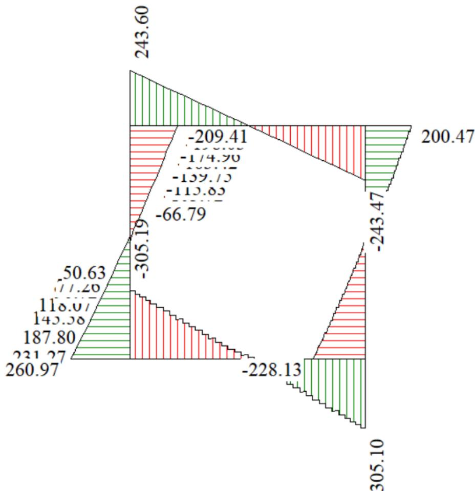
Inviluppo diagrammi del taglio flettente – SLU statico e sismico
