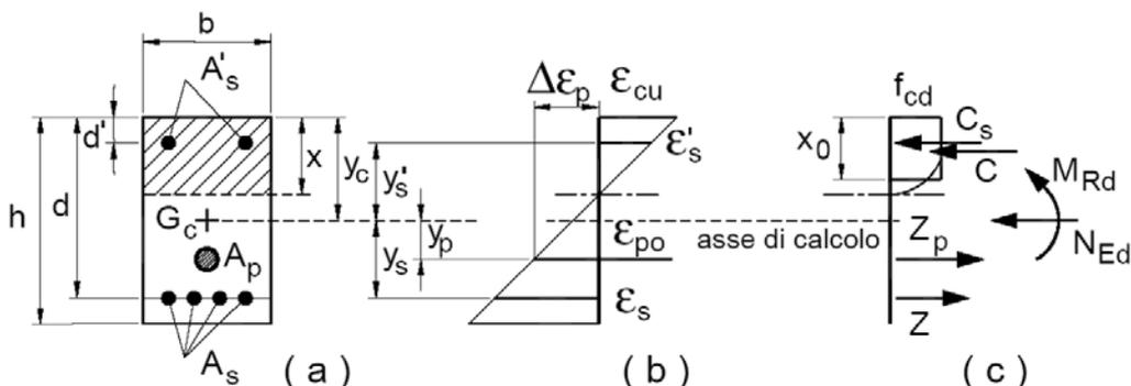
Schema di riferimento per la valutazione della capacità resistente a pressoflessione generica sezione -
