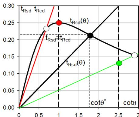
L'angolo effettivo di inclinazione delle bielle ( $\theta$ ) assunto nelle verifiche è stato in particolare valutato, nell'ambito di un problema di verifica, tenendo conto di quanto di seguito indicato :
