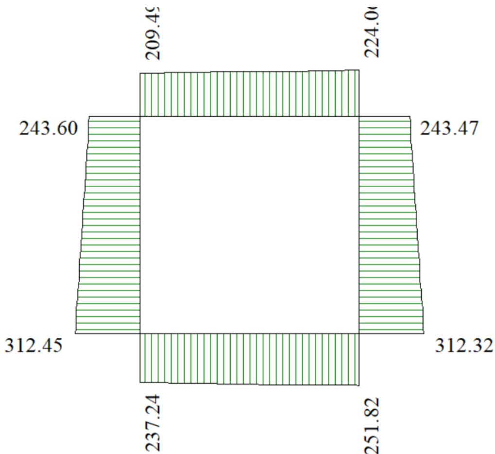
Inviluppo diagrammi dello sforzo normale – SLU statico e sismico
