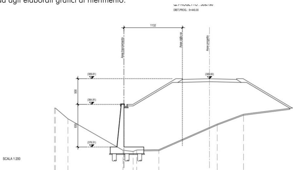
Figura 2.1 - Profilo longitudinale opera di sottoscarpa MU30
