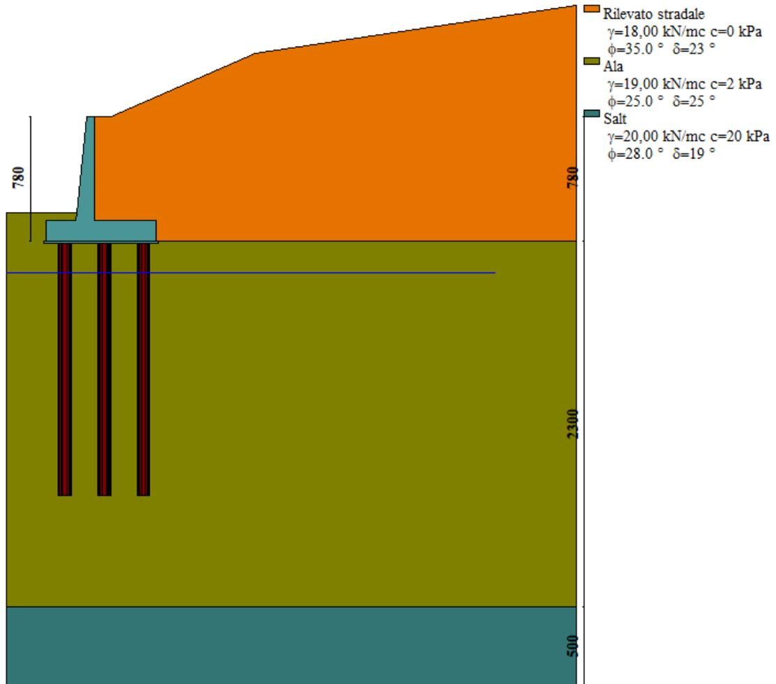
Modello di calcolo muro su PALI
