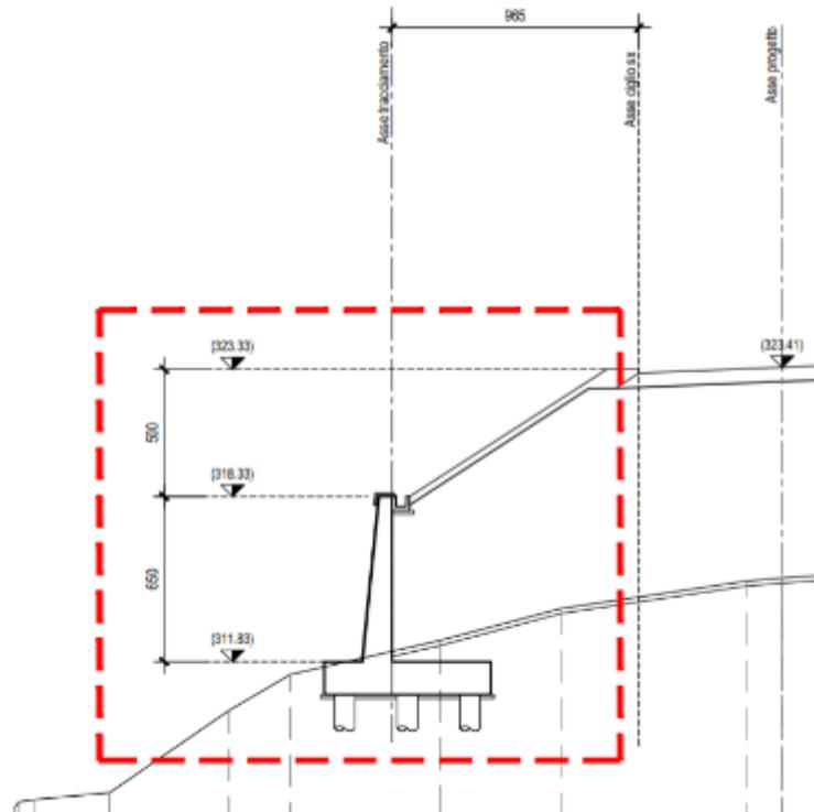
**Figura 2.2 – Sezione opera di sottoscarpa di tipo 3, Hparam=6.5m**
