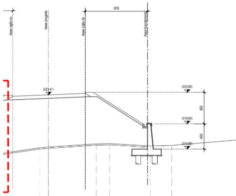
Figura 2.3 – Sezione opera di sottoscarpa di tipo 2, Hparam=4 m
