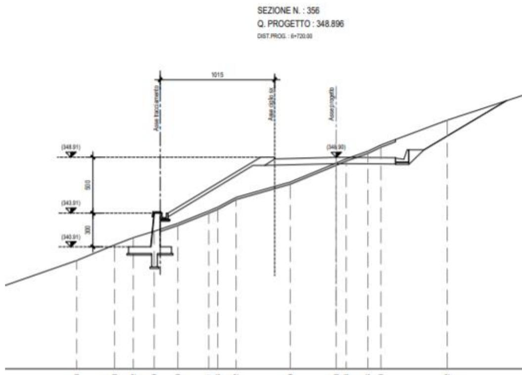
Figura 2.2 – Sezione opera di controripa di tipo 1, Hparam=3.0m
