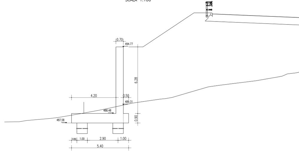
SEZIONE COSTRUTTIVA MURO DI SOTTOSCARPA IN C.A.
