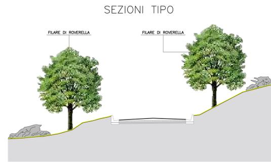
Schema di impianto per la misura di mitigazione M6
