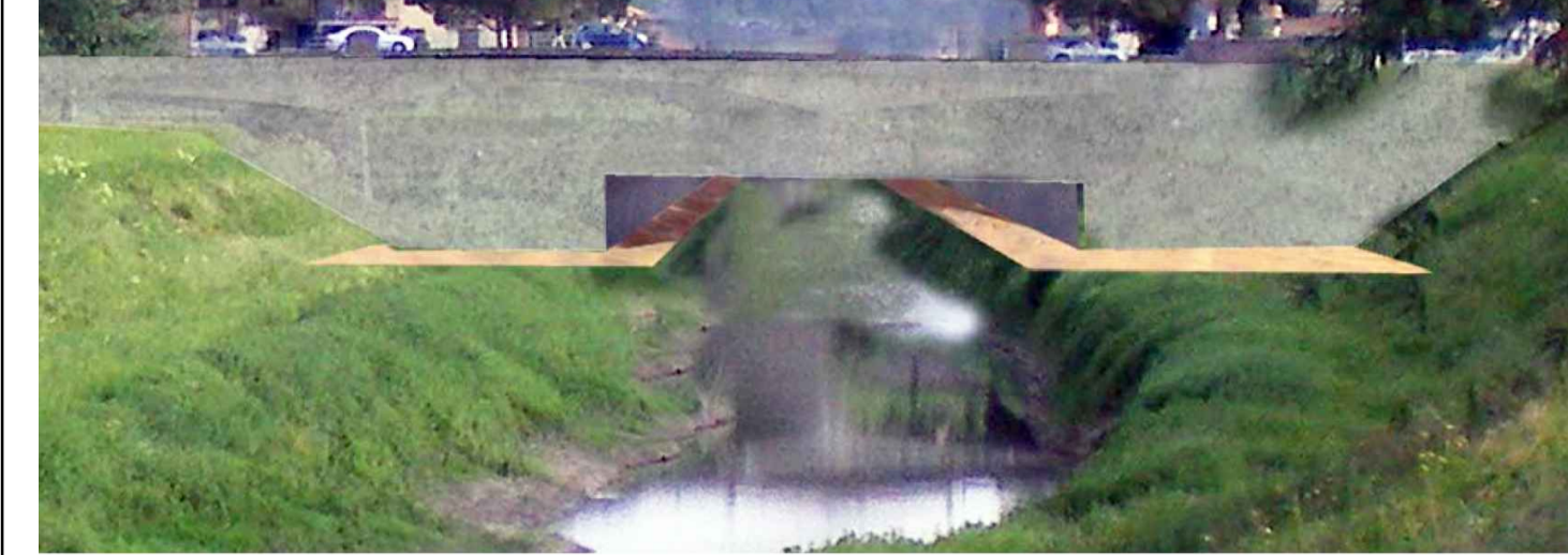
Configurazione sottopassi faunistici in tombini scatoalari
