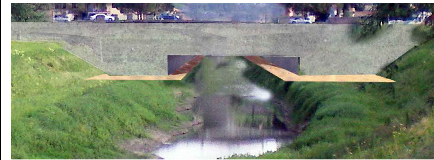
Configurazione sottopassi faunistici in tombini scatoletti
