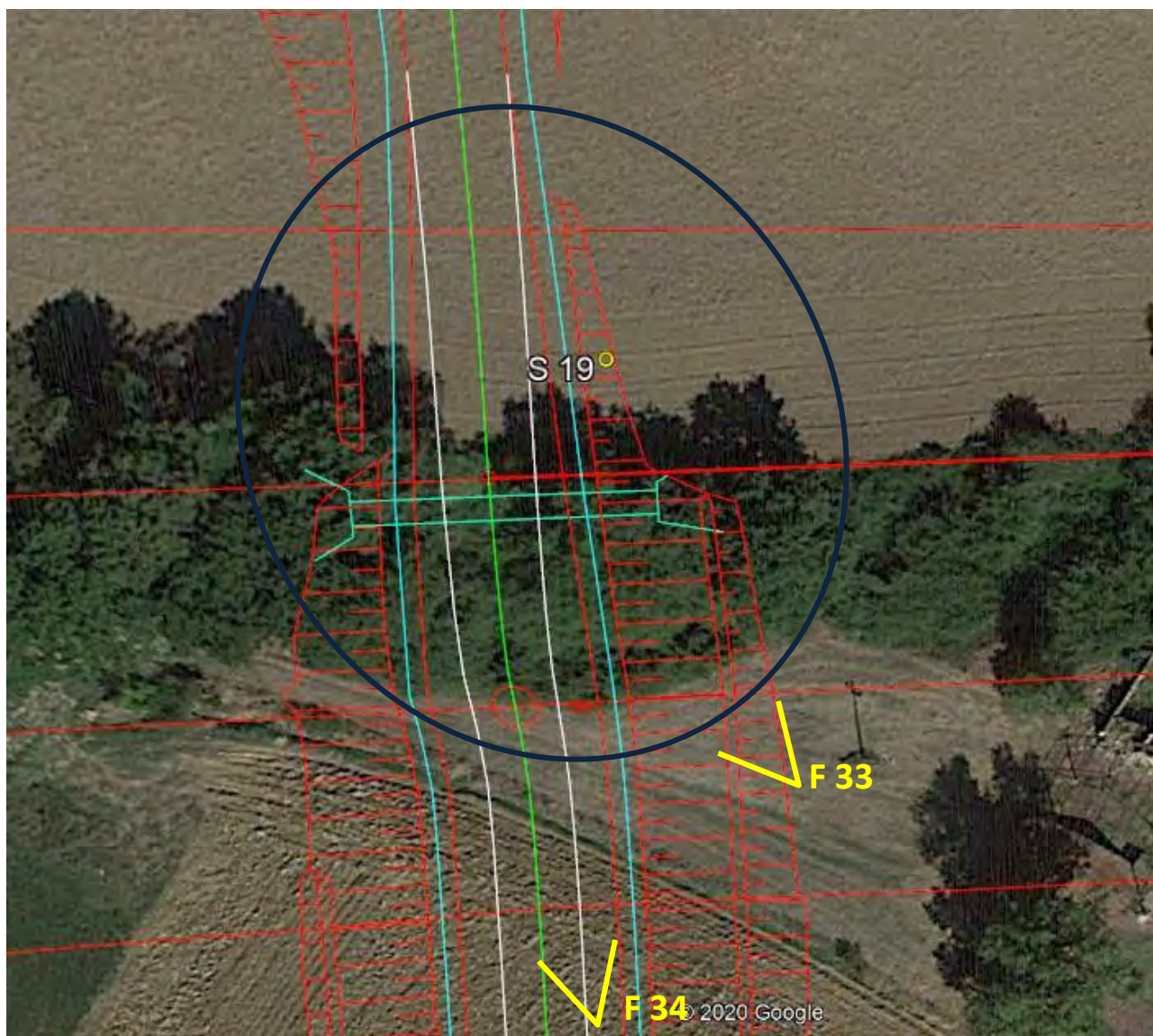
Tracciato in progetto su foto satellitare da Google Earth: In blu l'area indagata del sito S19 . In giallo i punti fotografici
