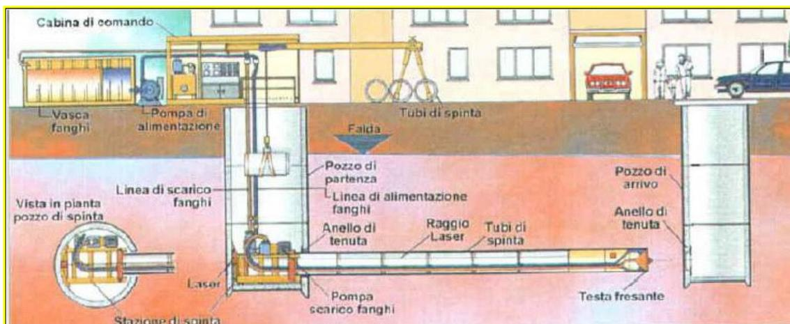
Figura 2-10 Schema di perforazione
