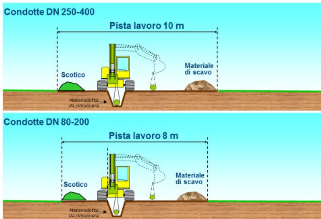
Figura 2-12 Pista di lavoro per rimozione condotta esistente
