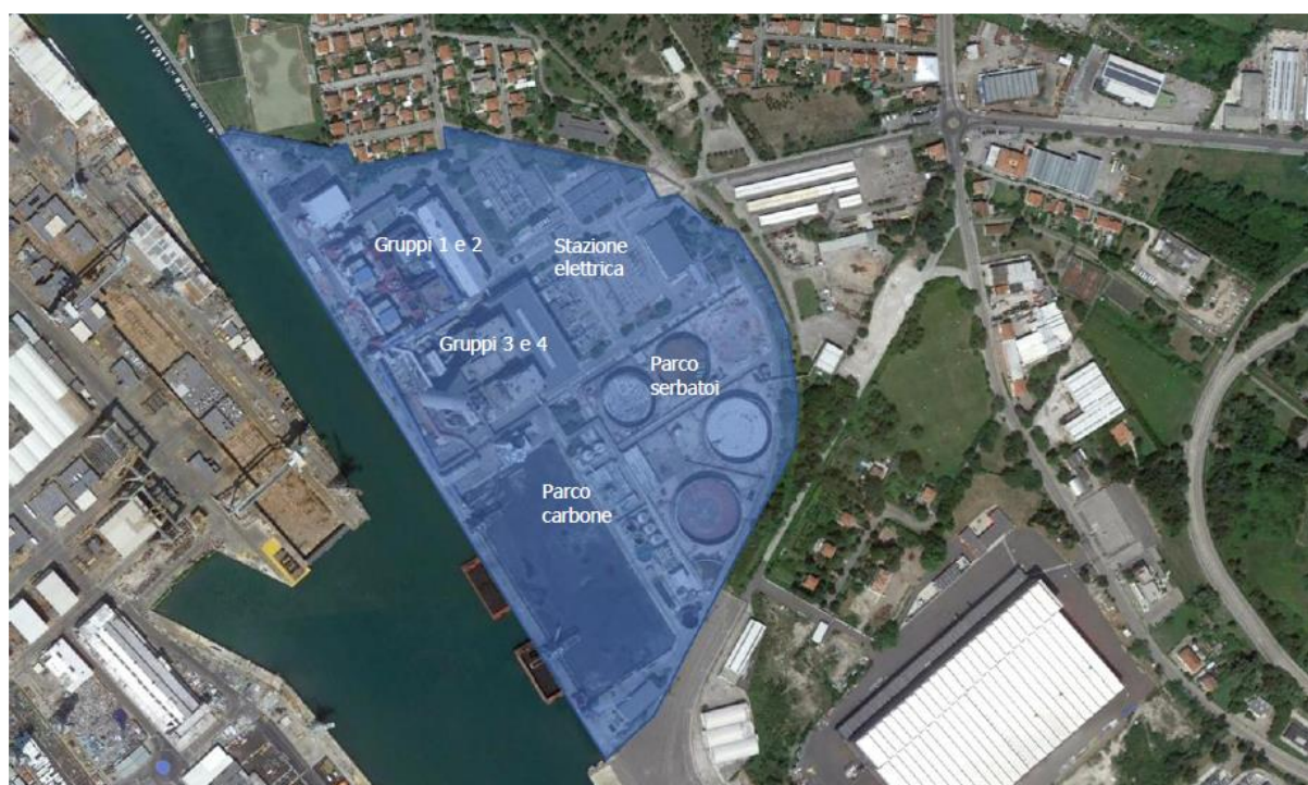
Figura 7 - Vista aerea (risalente al 2015) della centrale con individuazione delle aree operative
