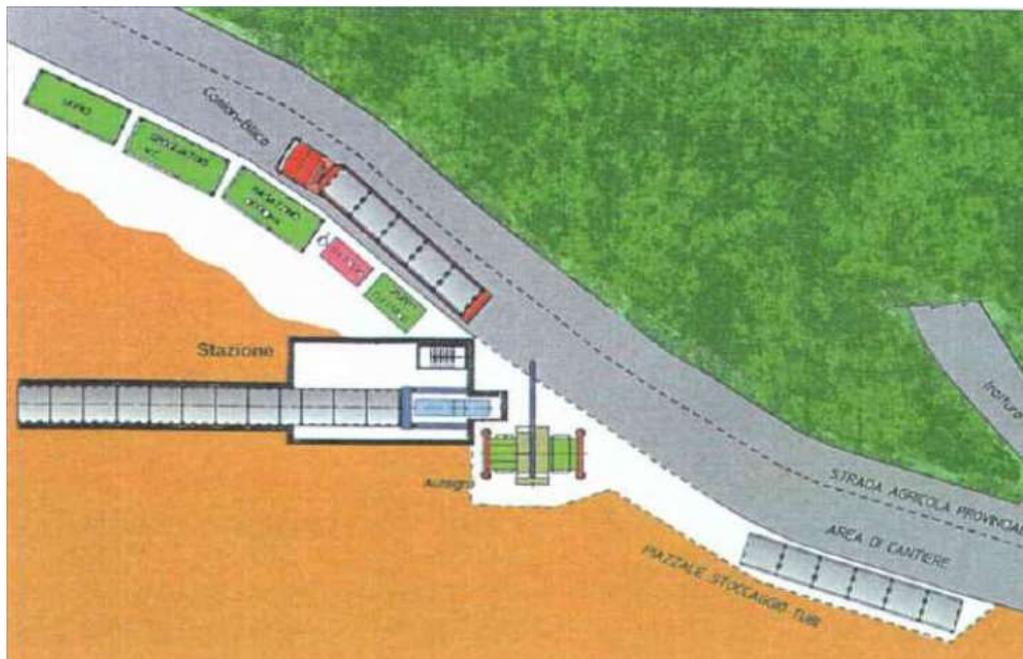
Figura 2-8 - Schema tipo di un cantiere per l'installazione di un microtunnel
