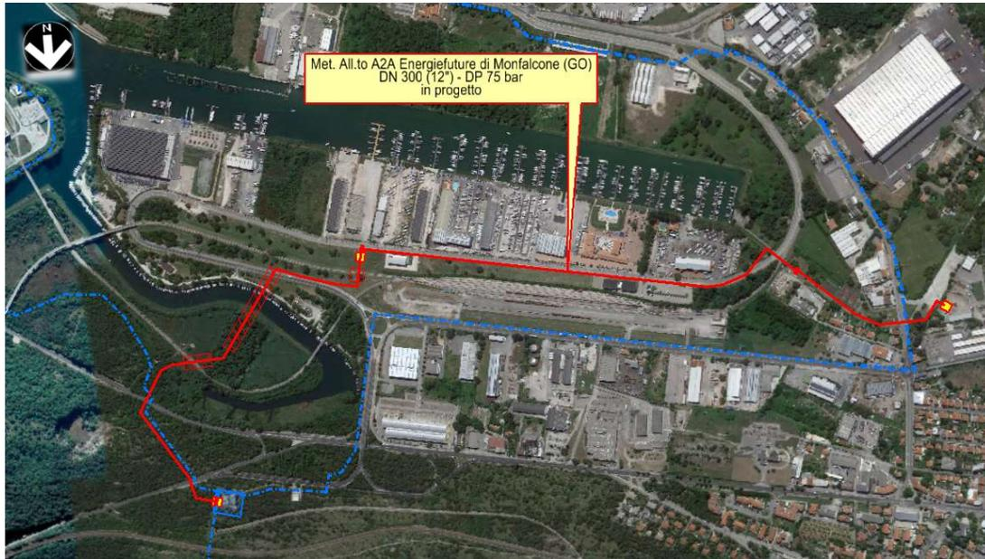
*Figura 1-1 – Opere in progetto. In giallo sono indicati i punti di linea, in rosso la condotta in progetto e in blu le linee esistenti.*
