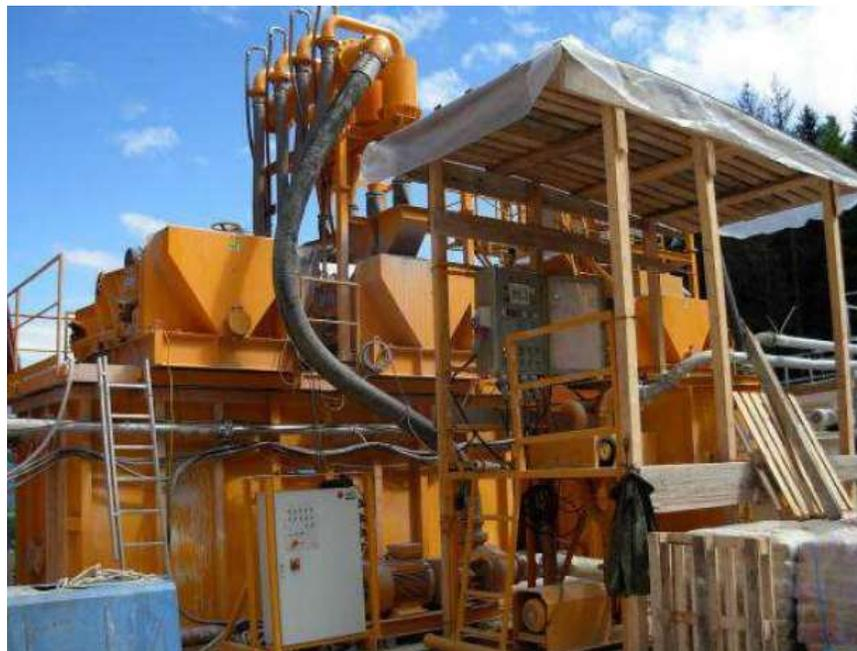
*Figura 2-10 - Sistema di disidratazione*
