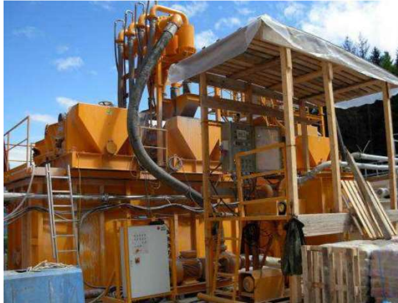
Figura 8-6 - Sistema di disidratazione
