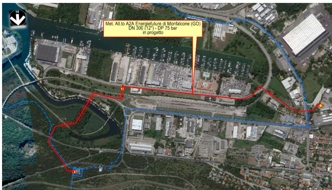
Figure 5-1 - Opere in progetto. In giallo sono indicati i punti di linea, in rosso la condotta in progetto e in blu le linee esistenti.
