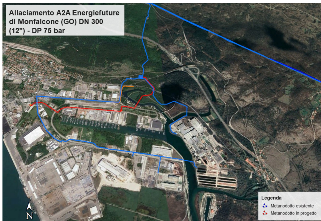
Fig. 3/B – Stralcio immagine aerea con localizzazione delle aree d'intervento (in rosso il tracciato di progetto ed in blu quello in esercizio)
