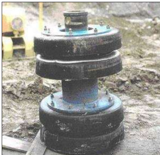
Figura 2-36 – Pig convenzionale impiegato in operazioni di collaudo idraulico e pulizia della condotta
