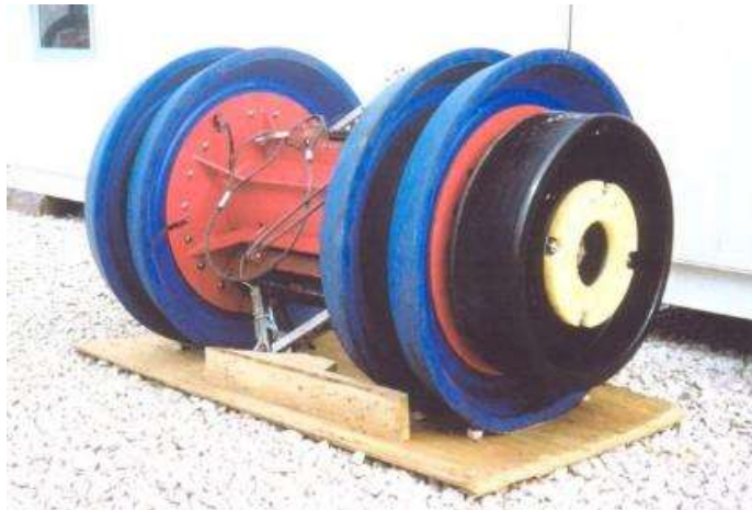
Figura 2-37 – Pig strumentale per il controllo della geometria e dello spessore della condotta
