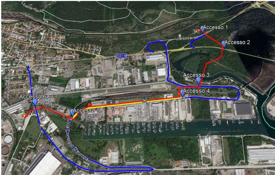
Figura 3-2 – Rappresentazione dei percorsi (in blu) dalla viabilità principale verso gli accessi al cantiere dell'allacciamento A2A Energiefuture di Monfalcone (in rosso); in giallo è indicato il tratto in progetto sotto la carreggiata.
