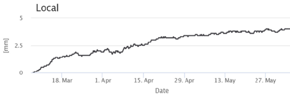
Figura 24: Andamento nel tempo degli spostamenti locali registrati da MEMS 3D alla profondità di 12 m. per l'inclinometro SA MUMS.
