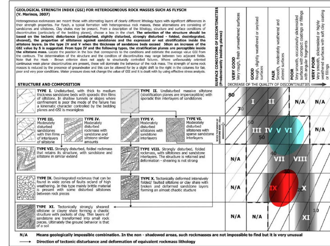
Indicazione dei valori di GSI (Geological Strength Index) (da V. Marinos, 2007) definiti per le Unità Geotecniche UG2 e UG3. In ciano il campo di variazione dell'unità UG2, in rosso il campo di variazione dell'unità UG3 (fanno parte dell'unità UG3 anche le zone di faglia).
