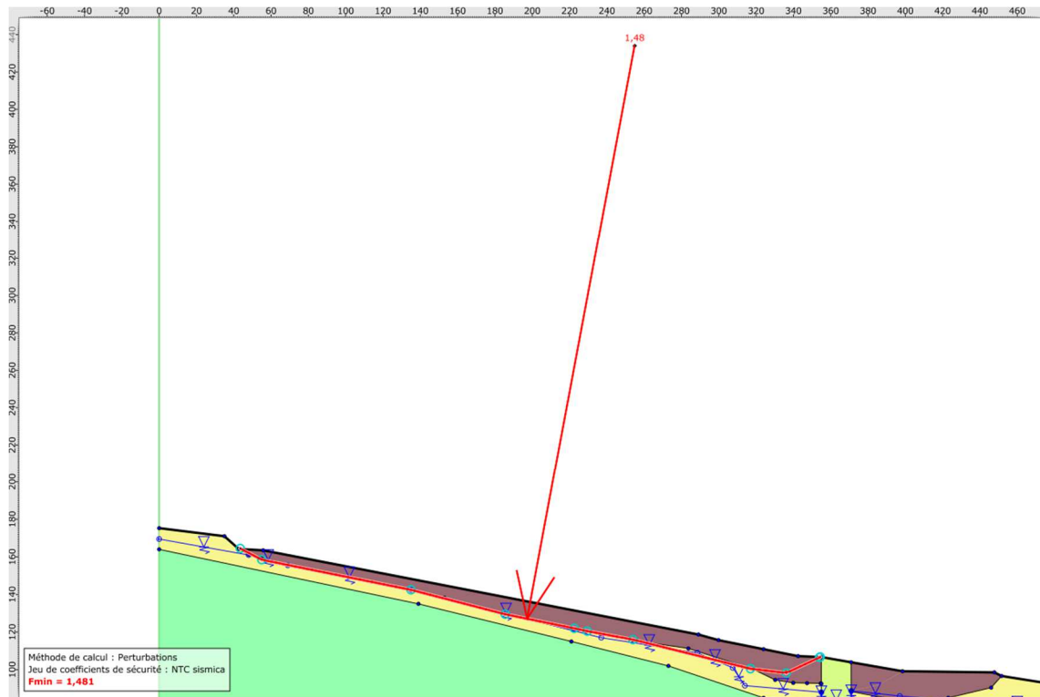
Figura 19 Analisi di stabilità del versante con interventi di drenaggio -Condizione statica – Metodo di calcolo delle Perturbazioni – Coefficiente di sicurezza sulla pregressa superficie di scorrimento FS = 1,46
