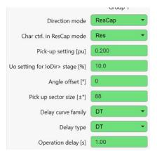
La regolazione per la protezione direzionale di terra (67N) si fa selezionando "Direction Mode" come "Sector", stabilendo una bisettrice per il settore di intervento (Angle offset) e impostando l'ampiezza di tale settore (Pick-up sector size).
