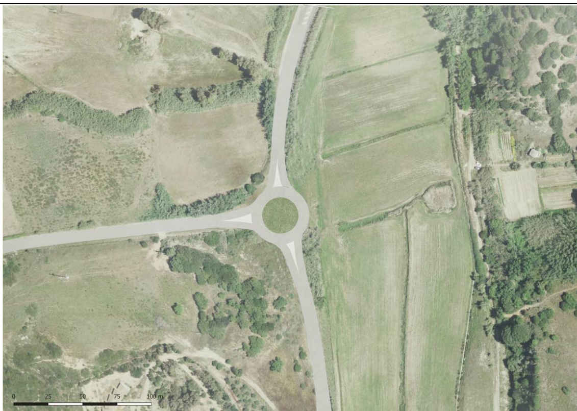
Foto aerea dello stato di fatto e simulazione dell'intervento Rotatoria R1 – km 26 + 500
