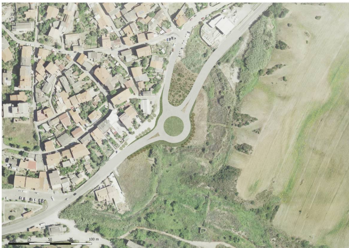
Foto aerea dello stato di fatto e simulazione dell'intervento rotatoria R3 – km 33+ 500
