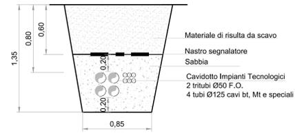
CAVIDOTTO IN RILEVATO CARREGGIATA NORD
