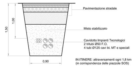
CAVIDOTTO IN RILEVATO CARREGGIATA NORD
