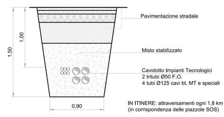
**CAVIDOTTO IN RILEVATO CARREGGIATA NORD**
