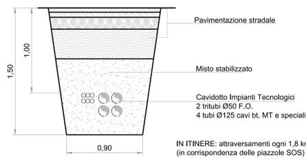
**CAVIDOTTO IN RILEVATO CARREGGIATA NORD**
