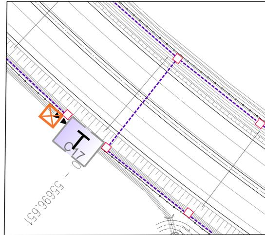
CAVIDOTTO IN RILEVATO CARREGGIATA NORD
